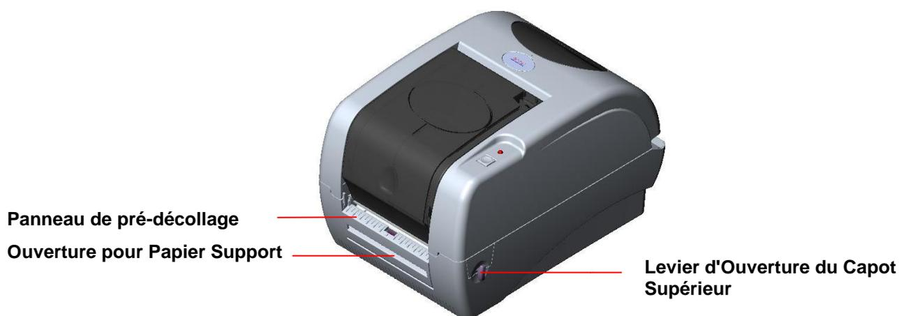
**Fig. 18 Ouvrir le capot supérieur**
