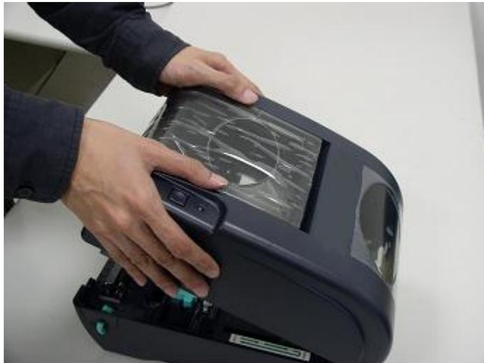
Fig. 3 Utilisez vos deux mains pour fermer le capot supérieur
