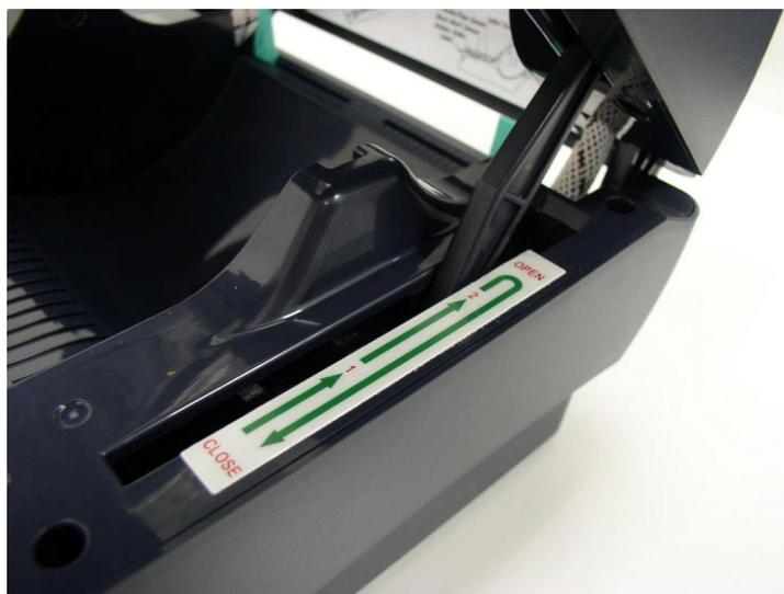
Fig. 1 Le support du capot supérieur est fixé en position 2
