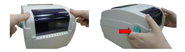
2. Un soporte de la tapa superior situado en la parte posterior de la impresora se enganchará con la tapa inferior interior para mantener abierta la tapa superior de la impresora.
