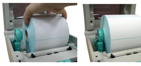
4. Presione el conmutador de bloqueo de las monturas de soportes hacia abajo para sujetar el rollo de etiquetas firmemente.
