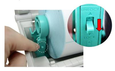
5. Coloque el papel, con el lado de impresión hacia arriba, a través del sensor de soportes y coloque el borde de cabecera de las etiquetas en el rodillo de la bandeja. Mueva las guías de los soportes para ajustar el ancho de las etiquetas girando el mando de ajuste de la guía. Desenganche el soporte de la tapa superior y cierre esta con cuidado.
