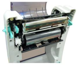
4. Inserte el lado derecho del núcleo del papel en el buje de rebobinado. Alinee las muescas situadas en el lado izquierdo y monte los radios.
