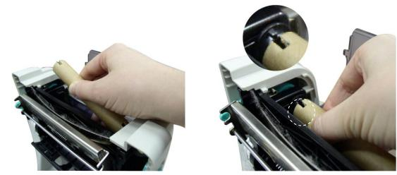
5. Pegue la cinta en el núcleo del papel de rebobinado de la cinta.
