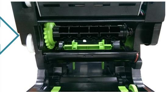
4. Drücken Sie zum Öffnen des Druckkopfmechanismus die Druckkopf-Freigabetaste.
