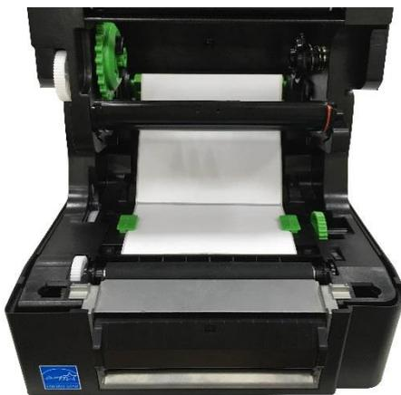
3. Drücken Sie die Druckkopf-Freigabetaste zum Öffnen des Druckkopfmechanismus und führen Sie das Medium durch den Mediensensor. Verschieben Sie die Medienführungen passend zur Etikettenbreite.
