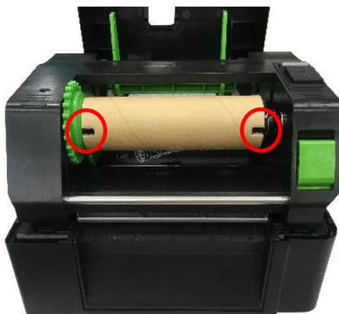
3. Stecken Sie die rechte Seite der Farbbandaufwickelspindel zuerst ein. Setzen Sie dann die linke Seite in das Loch auf der linken Seite des Farbbandaufwickelhubs (grün) ein.
