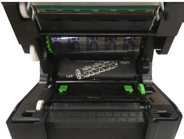
6. Setzen Sie die rechte Seite der Farbbandversorgungsspindel (mit „R“ gekennzeichnet) zunächst in den Farbbandversorgungshub ein. Setzen Sie dann die linke Seite der Farbbandversorgungsspindel in das Loch auf der linken Seite des Farbbandversorgungshubs (grün) ein.
