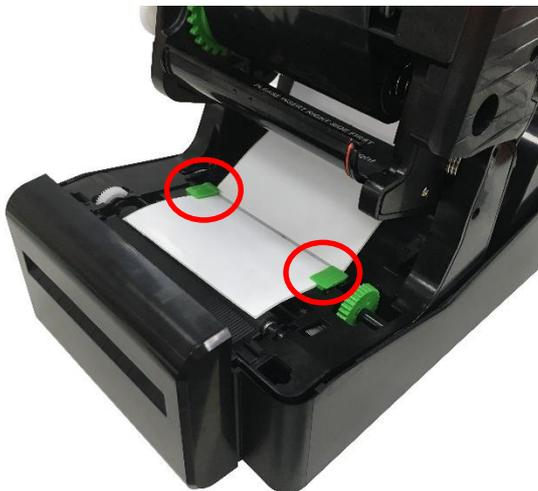
3. Drücken Sie die Druckkopf-Freigabetaste zum Öffnen des Druckkopfmechanismus und führen Sie das Medium durch den Mediensensor. Verschieben Sie die Medienführungen passend zur Etikettenbreite.
