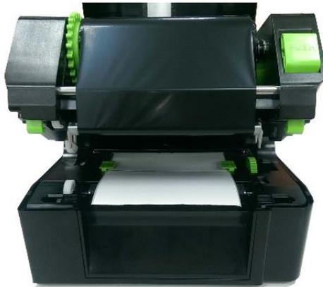
5. Führen Sie das Papier mit der bedruckbaren Seite nach oben durch den Mediensensor, platzieren Sie die Vorderkante auf der Walze. Verschieben Sie die Medienführungen passend zur Etikettenbreite.
