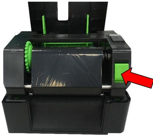
4. Drücken Sie zum Öffnen des Druckkopfmechanismus die Druckkopf-Freigabetaste.
