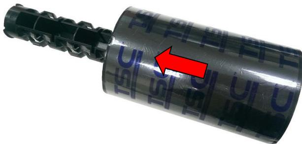
5. Installieren Sie das Farbband auf der Farbbandspindel.
