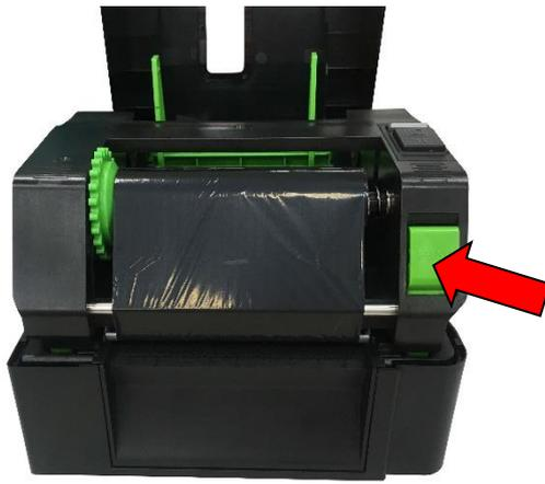
4. Spingere la leva di sblocco della testina per aprire il meccanismo della testina.
