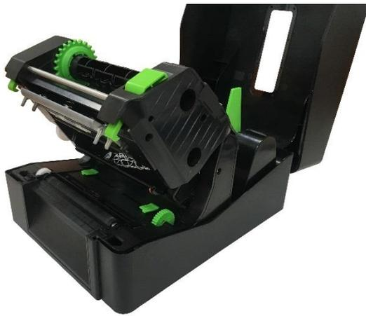
4. Fare riferimento al capitolo 3.3.1 per l'installazione delle etichette. Usare "Diagnostic Tool (Strumento di diagnostica)" per impostare il tipo di sensore e calibrare il sensore selezionato.
