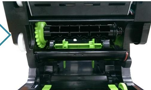
4. Spingere la leva di sblocco della testina per aprire il meccanismo della testina.
