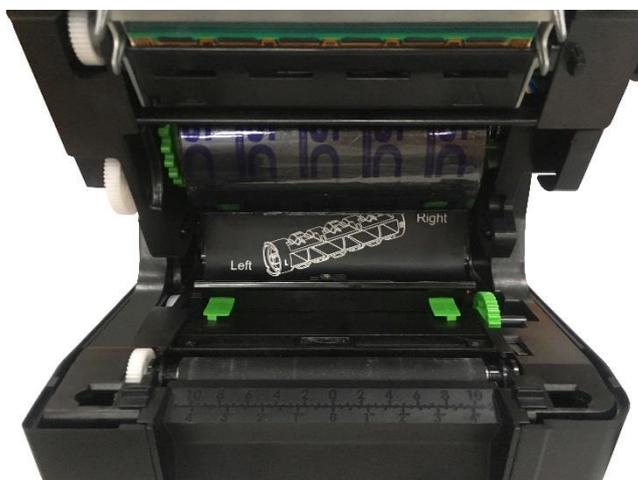
6. Inserire il lato destro del mandrino di alimentazione del nastro (contrassegnato con "R") prima sul mozzo di alimentazione del nastro. Quindi, inserire il lato sinistro nel foro sul lato sinistro del mozzo di riavvolgimento nastro (verde).
