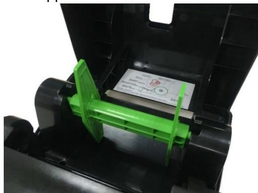
Mandrino per supporto fissato con due linguette di fissaggio e due adattatori da 1,5"
