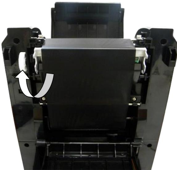
8. Drehen Sie das Aufwickelzahnrad, bis der Kunststoffvorlauf fest aufgewickelt ist. Schließen Sie Farbbandabdeckung und obere Abdeckung.
