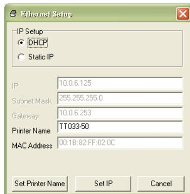
Per Vorgabe wird die IP-Adresse automatisch über DHCP abgerufen. Falls Sie eine feste IP-Adresse vergeben möchten, klicken Sie auf die „Static IP (Statische IP)“-Schaltfläche und geben anschließend IP-Adresse, Subnetzmaske und Gateway ein. Anschließend klicken Sie auf „Set IP (IP festlegen)“, damit die geänderten Einstellungen in Kraft treten.
