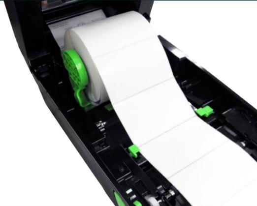
1. Bitte beachten Sie Abschnitt 3.3.1 zum Führen des Papiers mit der bedruckbaren Seite nach oben durch die Papierführung und über die Ausgabewalze.
