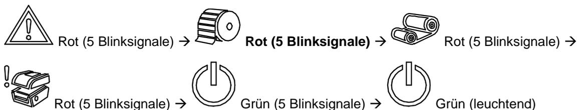
4. Nach der Sensorkalibrierung wird die Etikettenlänge gemessen, die internen Einstellungen werden ausgedruckt, anschließend wechselt das Gerät in den Speicherauszugmodus.
