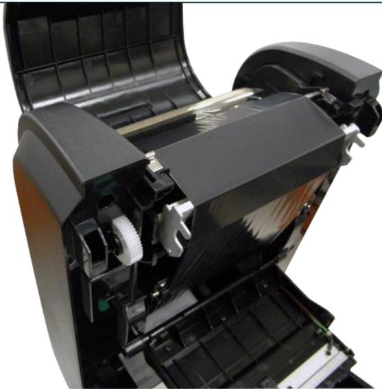
7. Befestigen Sie das Band mit einem Stückchen Klebeband an der Aufwickelwalze.
