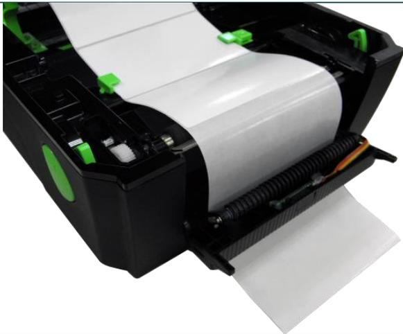
5. Öffnen Sie die Abziehabdeckung. Führen Sie das Tragband durch den Schlitz der Abziehabdeckung.
