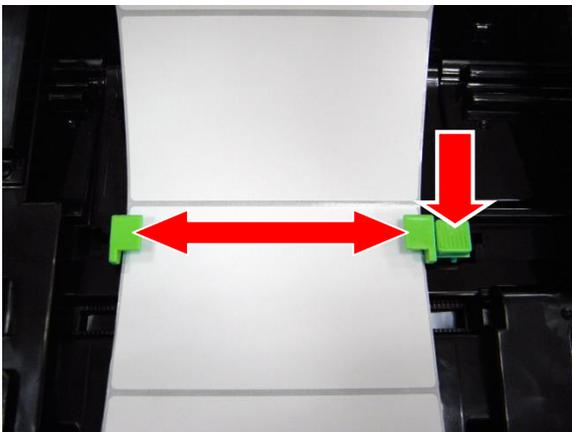
2. Verschieben Sie die Medienführungen durch Drücken des Führungseinstellknopfes passend zur Medienbreite.
