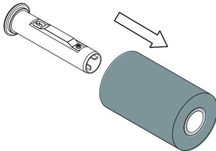
5. Installieren Sie das Farbbandspindel im Farbbandkern.
