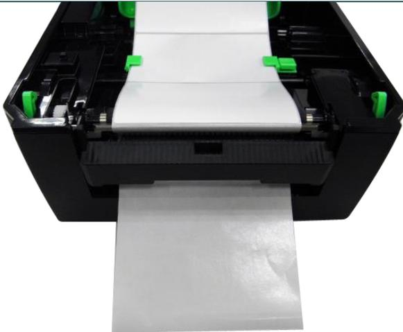
6. Schließen Sie Abzieh- und Druckerabdeckung. Der Drucker ist bereit für den Abziehmodus.
