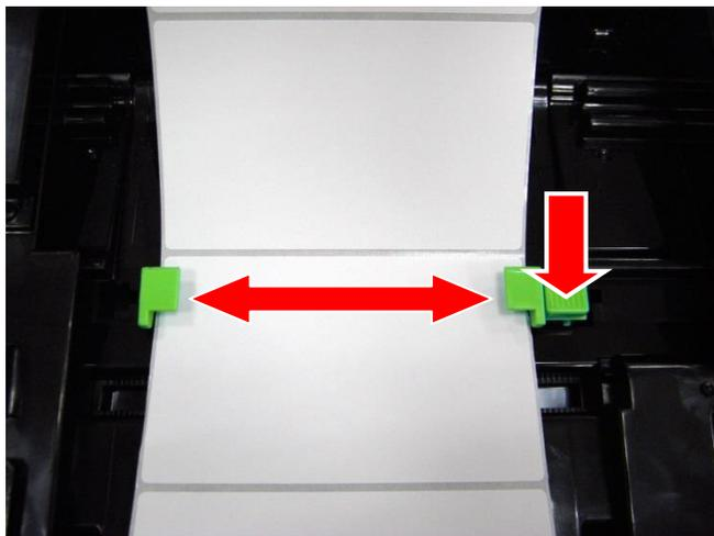
5. Verschieben Sie die Medienführungen durch Drücken des Führungseinstellknopfes passend zur Medienbreite.
