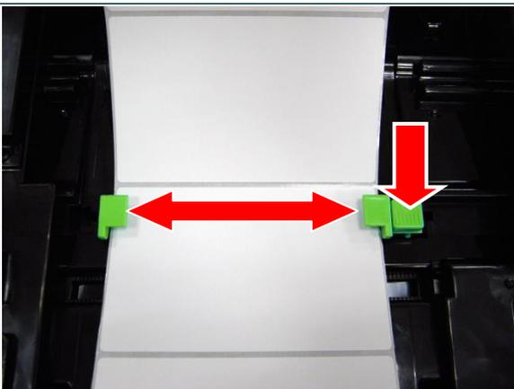
3. Verschieben Sie die Medienführungen durch Drücken des Führungseinstellknopfes passend zur Medienbreite.
