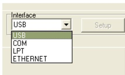
5. Klicken Sie im Register „Printer Configuration (Druckerkonfiguration)“ auf die „Ethernet Setup (Netzwerkeinstellungen)“-Schaltfläche im Abschnitt „Printer Function (Druckerfunktionen)“. Hier können Sie IP-Adresse, Subnetzmaske und Gateway des integrierten Netzwerkadapters einstellen.
