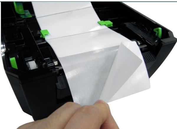
4. Öffnen Sie die obere Abdeckung sorgfältig. Ziehen Sie das Medium durch die Vorderseite des Druckers, nehmen Sie einige Etiketten ab und lassen nur das Tragband zurück.
