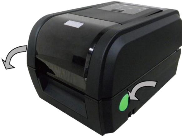
1. Ouvrez le couvercle supérieur de l'imprimante en tirant les loquets situés de chaque côté vers l'avant de l'imprimante et en soulevant le couvercle supérieur pour l'ouvrir au maximum.
