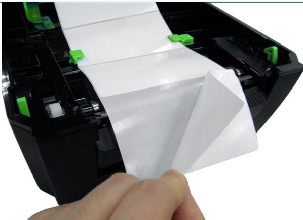
4. Ouvrez doucement le couvercle supérieur. Tirez l'étiquette vers l'avant de l'imprimante et retirez quelques étiquettes, ne gardez que le liner.
