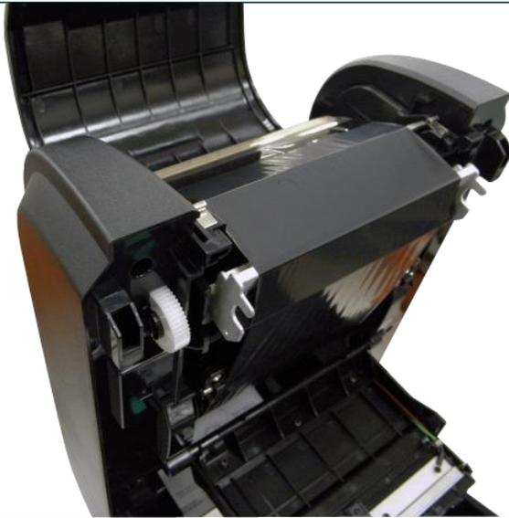
7. Fixez le ruban sur le mandrin en papier pour le rembobinage du ruban.
