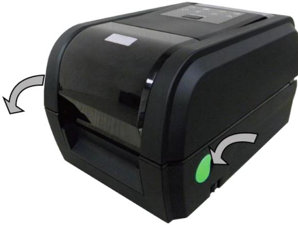
1. Ouvrez le couvercle supérieur de l'imprimante en tirant les leviers d'ouverture du couvercle supérieur situés de chaque côté de l'imprimante et en soulevant le couvercle supérieur pour l'ouvrir au maximum.
