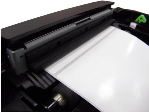
2. Insérez le papier dans l'ouverture du module de découpage papier (Cutter).
