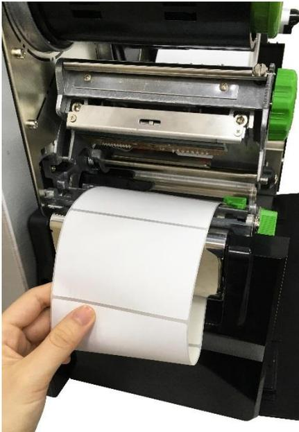
6. Levante la palanca de liberación del cabezal de impresión y la palanca de liberación de la barra de guía de etiquetas para pasar unos 650 mm de la etiqueta por la parte frontal de la impresora.
