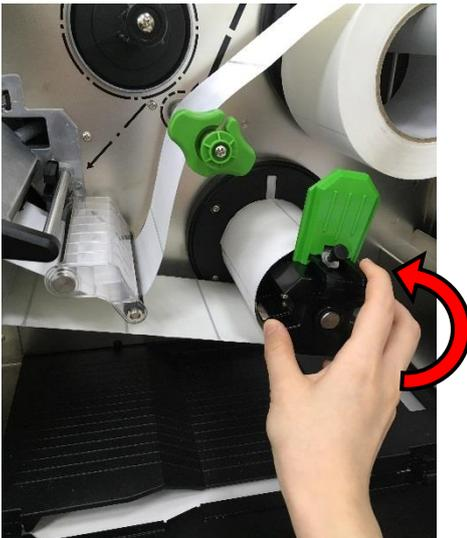
8. Coloque la etiqueta en el eje de rebobinado interno y coloque la etiqueta en el núcleo de papel. Gire el eje en sentido contrario a las agujas del reloj hasta que la etiqueta esté correctamente estirada.
