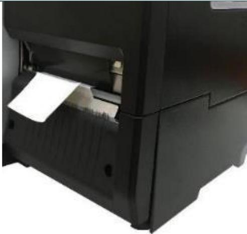
8. Cierre la palanca de liberación del cabezal de impresión y utilice el panel de visualización frontal para configurar el modo de impresión en "Despegar".
