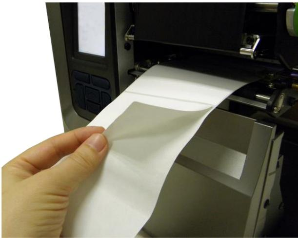
4. Öffnen Sie den Druckkopf-Freigabehebel und den Etikettenführungsschiene-Freigabehebel und ziehen Sie etwa 650 mm des Mediums durch die Vorderseite des Druckers.
