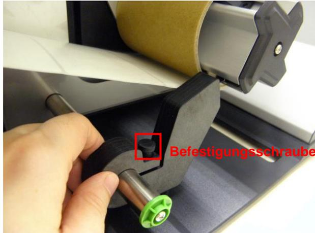
8. Passen Sie die Versorgungshalterführung entsprechend der Versorgungsbreite an. Drehen Sie die Schraube zur Befestigung der Versorgungshalterführung.
