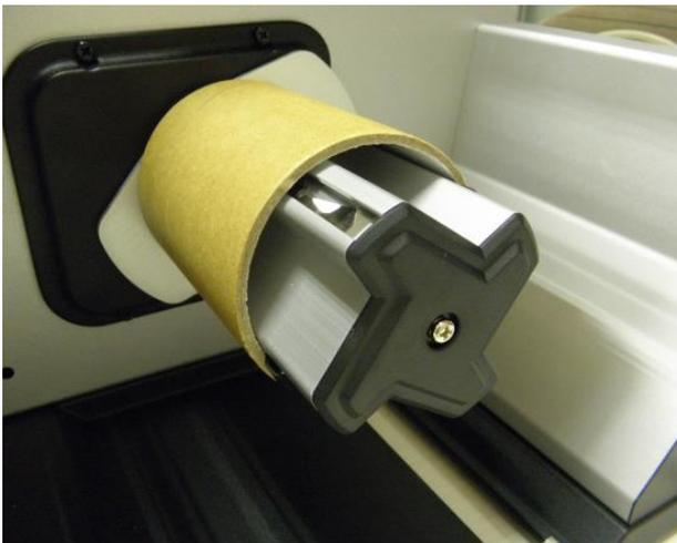
6. Installieren Sie die Aufwickelwalze auf der Tragband-Aufwickelspindel. Öffnen Sie den Freigabehebel der Abziehrolle.
