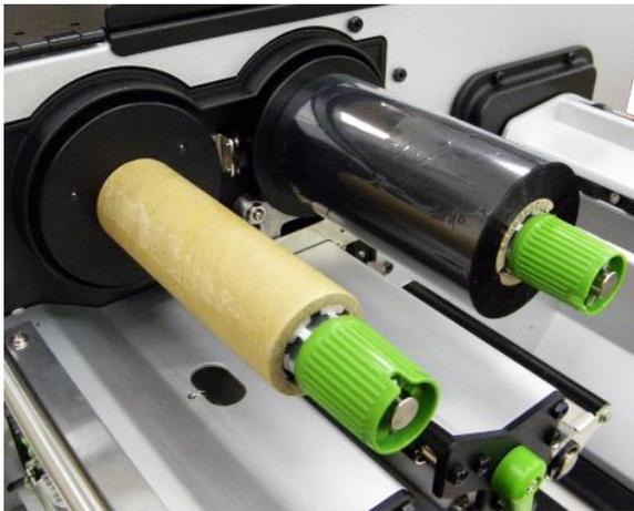
2. Installieren Sie Farbband und Aufwickelwalze auf der Farbbandversorgungsspindel und der Farbband-Aufwickelspindel.
