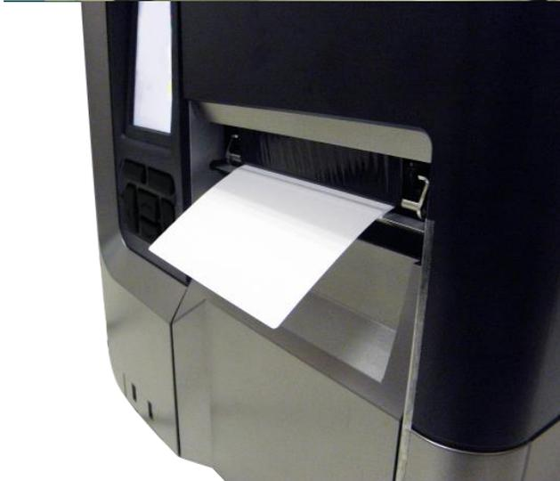
11. Drücken Sie die Zuführungstaste zur Probe.
