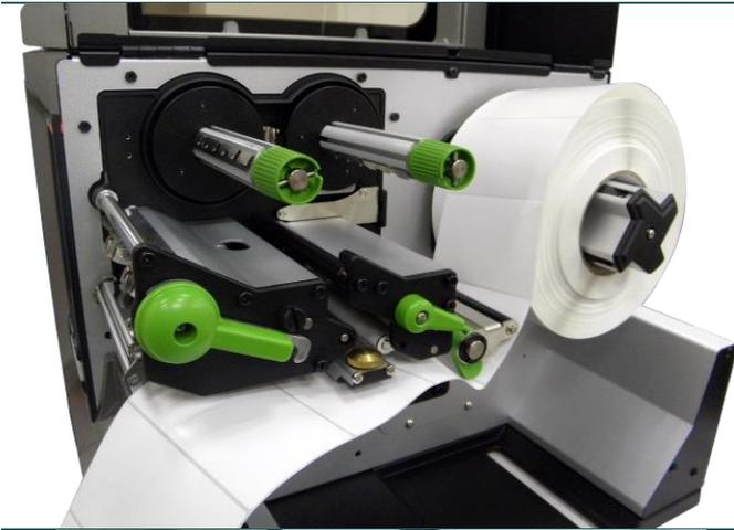
4. Ziehen Sie die Etikettenrollen-Vorderkante nach vorne durch die Medienführungsschiene vorbei am Mediensensor; platzieren Sie die Vorderkante auf der Druckwalze.
