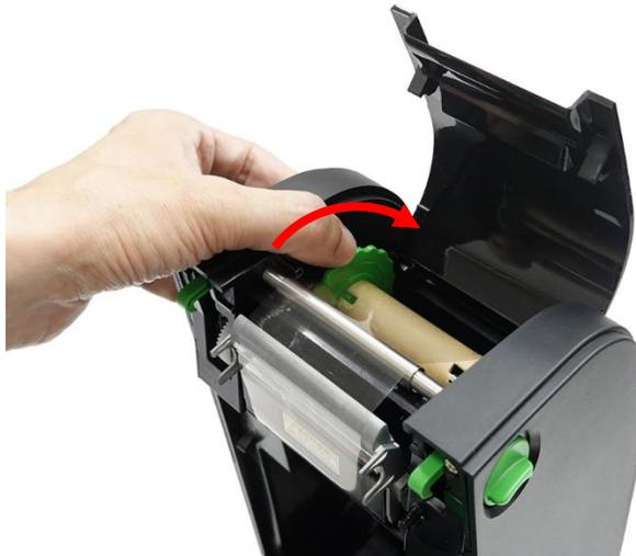
**8.** Siga girando el engranaje mencionado hasta que la cinta cubra completamente el cabezal de impresión y elimine las arrugas que haya en la cinta.
