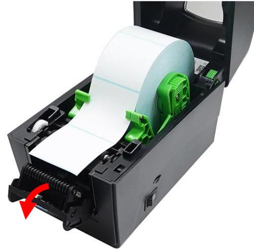
5. Retire algunos trozos de etiqueta del revestimiento antiadherente. 6. Pase el soporte por la abertura del módulo de exfoliación.
