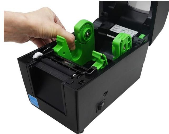
3. Cargue el rollo de soporte en la impresora asegurándose de que la cara imprimible del soporte queda orientada hacia arriba.
