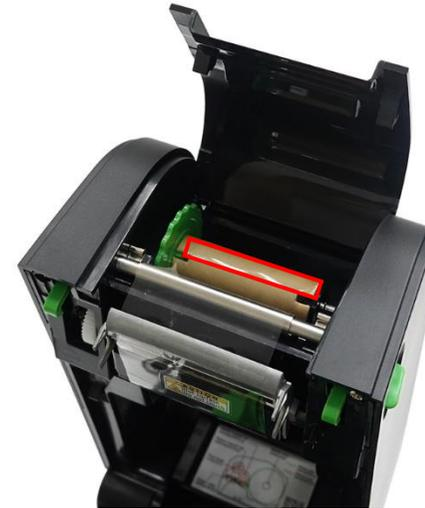
**7.** Gire el engranaje en la dirección indicada hasta que la cinta cubra completamente el cabezal de impresión.
