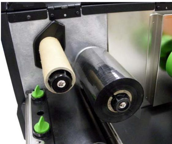
2. リボンおよびペーパーコアをリボンサプライスピンドルとリボン巻き戻しスピンドルに取り付けます。ペーパーコアとリボンロールをスピンドルの終わりまで押し込みます。
