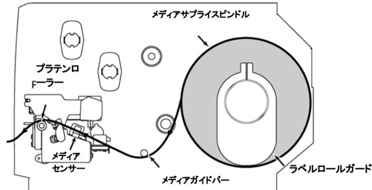
(7) フロントディスプレイパネルを使ってメディアセンサーの種類をセットし、選択したセンサーを校正します。(見開きページの「メディアセンサー校正」を参照してください)
