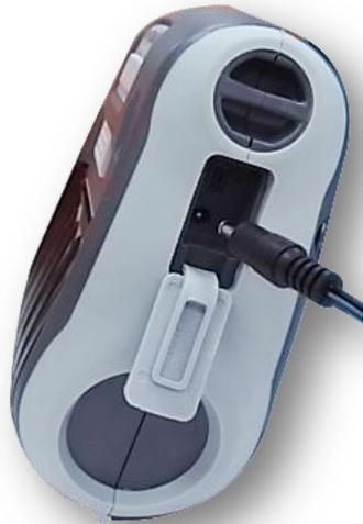
1. Öffnen Sie die Anschlussabdeckung und verbinden das Netzkabel mit dem Netzanschluss.
