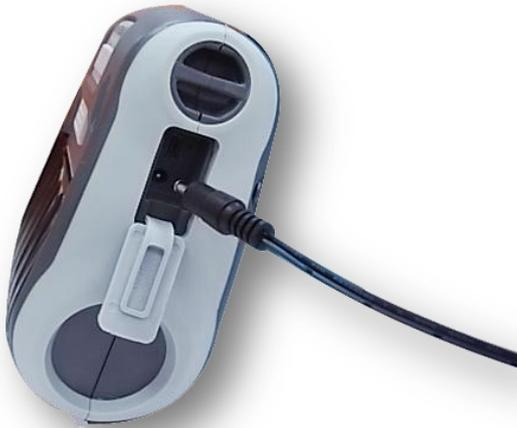
1. Öffnen Sie die Anschlussabdeckung und verbinden das Netzkabel mit dem Netzanschluss.
