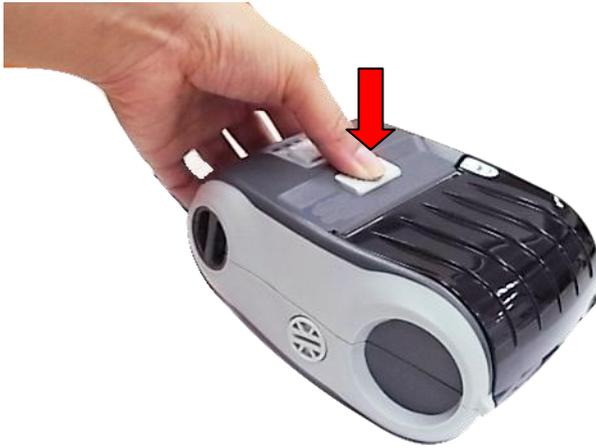
1. Öffnen Sie die Druckermedienabdeckung, indem Sie den Medienabdeckung-Freigabe-knopf drücken.
