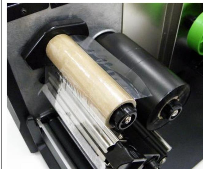
5. Befestigen Sie das Farbband mit einem Stückchen Klebeband an der Aufwickelwalze. Halten Sie das Farbband flach und faltenfrei.
