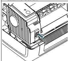
(4) Drücken Sie die Druckkopf-Freigabetaste zum Öffnen des Druckkopfmechanismus.
