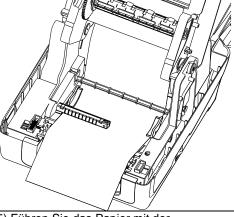
5) Führen Sie das Papier mit der bedruckbaren Seite nach oben durch die Medienführung und den Mediensensor, platzieren Sie die Vorderkante auf der Walze. Verschieben Sie die Medienführungen passend zur Etikettenbreite.
