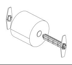
(2) Setzen Sie die Medienversorgungsspindel in die Papierrolle ein; befestigen Sie die Papierrolle mit zwei Befestigungslaschen an der Mitte der Spindel.
