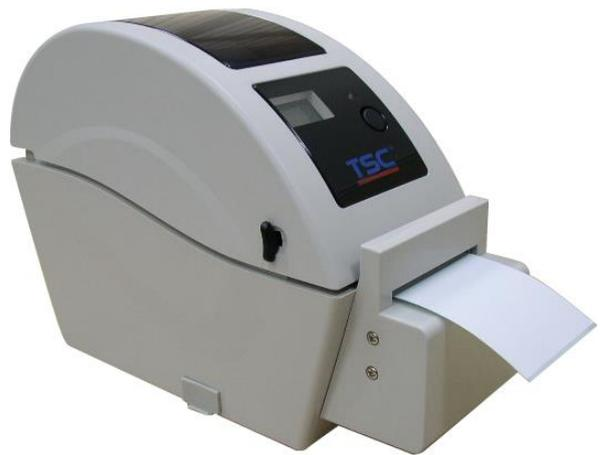
4. Legen Sie mit der "Diagnostic Tool" (Diagnosesoftware) den Mediensensortyp fest, kalibrieren Sie den ausgewählten Sensor. ("Diagnostic Tool" (Diagnosesoftware) starten → "Printer Configuration" (Druckerkonfiguration)-Register wählen → "Calibrate Sensor" (Sensor kalibrieren)-Schaltfläche anklicken)
