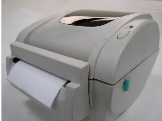
Abb. 19 Etikettenrolleninstallation im Schneidemodus erledigt
