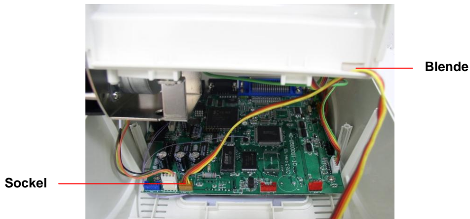
Abb. 16 Kabel der Schneideeinrichtung verlegen
