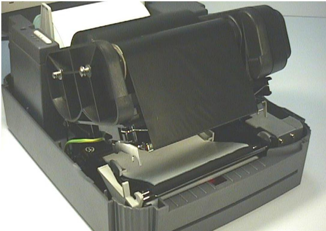
**Рис. 10. Установка рулона этикеток и ленты для термопереноса**
