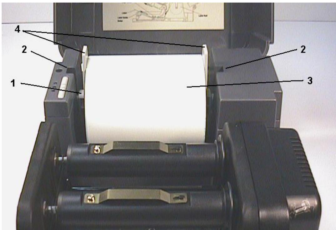
**Рис. 5. Установка рулона подачи этикеток в держатель рулона этикеток**
