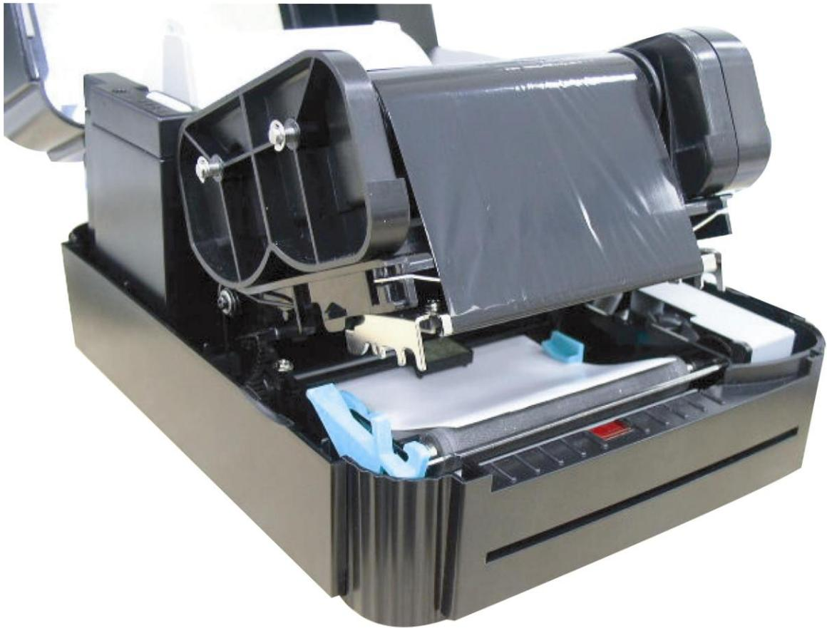
**Abb. 10 Die Etikettenrolle und das Thermotransfer-Farbband installieren**
