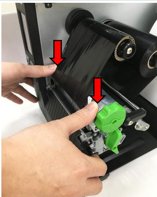
7. Fermez le mécanisme de la tête d'impression en appuyant sur les deux cotés du levier de dégagement de la tête d'impression.
