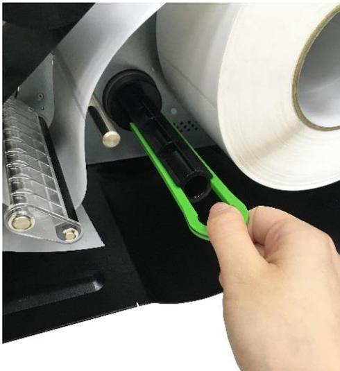
7. Retirez le clip de maintien de l'axe de rembobinage du consommable. Enroulez le consommable sur l'axe jusqu'à ce que le papier support soit bien tendu.
