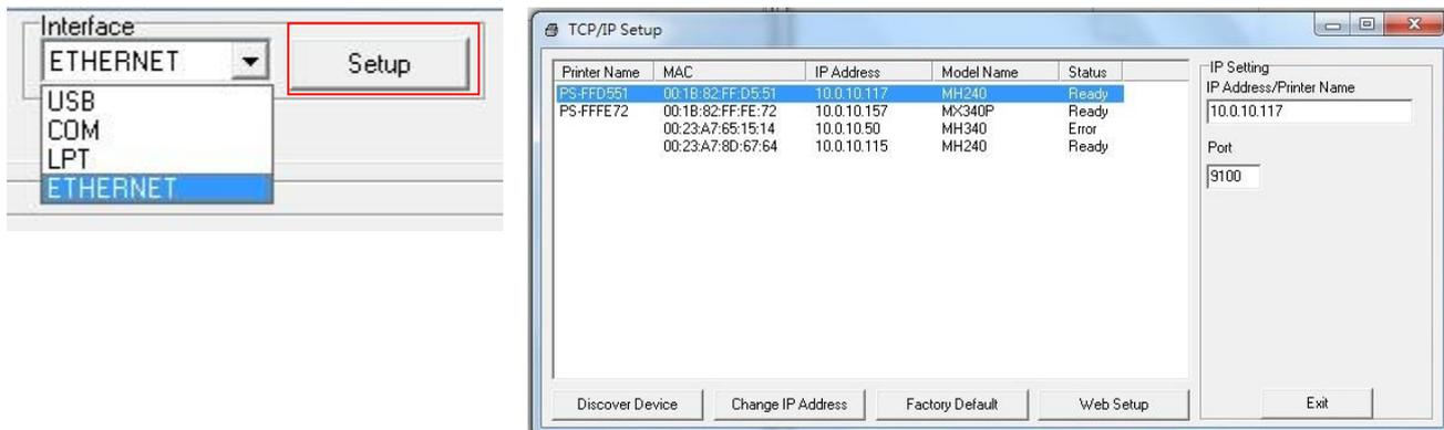
5. Cliquez sur le bouton "Discover Device (Découvrir appareil)" pour rechercher les imprimantes du réseau.
