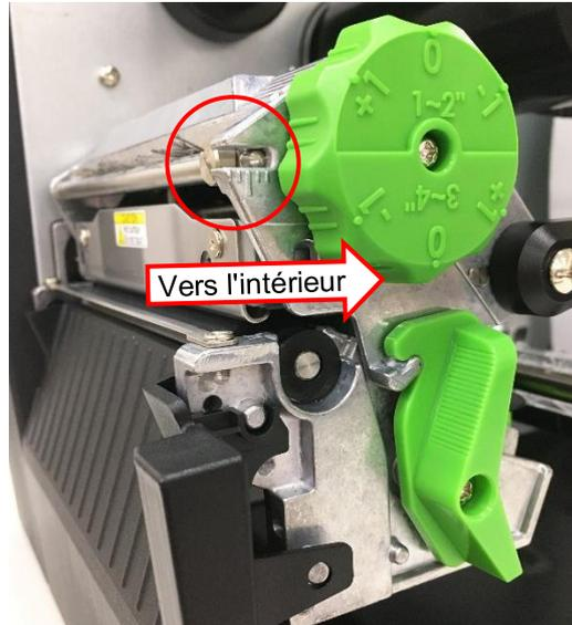
2. Si la molette de réglage de la tension du ruban a été positionnée sur le niveau du côté le plus à l'intérieur mais n'a pas résolu le problème de pli du ruban, veuillez ajuster la molette de réglage de la pression de la tête d'impression d'1 niveau et imprimez à nouveau l'étiquette pour vérifier si le pli a disparu.
