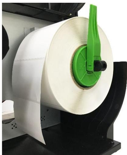
3. Placez le rouleau de consommable sur l'axe d'alimentation des étiquettes et utilisez la barre de retenue du rouleau d'étiquettes pour le fixer.
