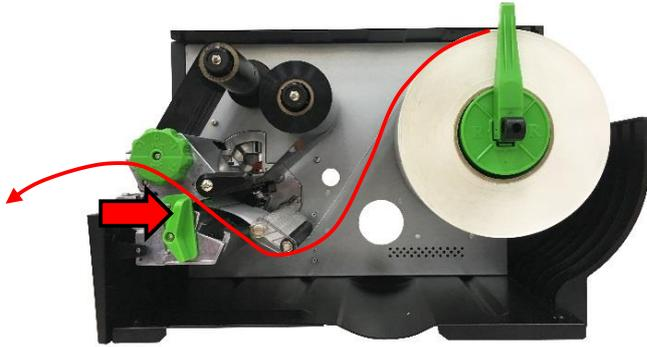
4. Poussez le levier de dégagement de la tête d'impression et installez l'étiquette via le rouleau tendeur, le capteur de consommable et le guide-étiquette pour installer le consommable.
