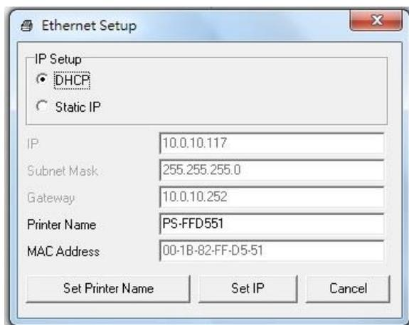
L'adresse IP est obtenue par défaut via DHCP. Pour changer le réglage sur Adresse IP statique, cliquez sur le bouton radio "Static IP ( réseau et la-IP statique)" puis entrez l'adresse IP, le masque de sous passerelle. Cliquez sur "Régler IP" pour confirmer les réglages.
