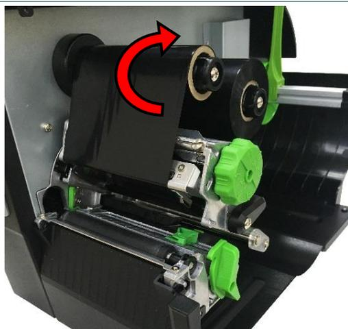
6. Faites tourner le ruban dans le sens inverse des aiguilles d'une montre d'environ 3 à 5 tours sur l'axe de rembobinage, jusqu'à ce que le ruban tourne facilement et qu'il soit correctement tendu et sans plis.
