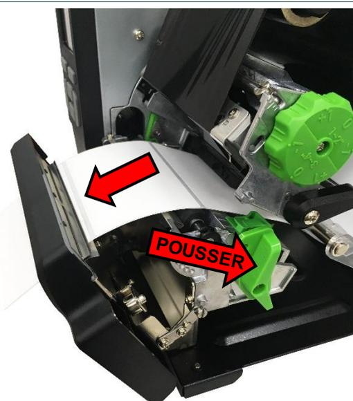
4. Poussez le levier de dégagement de la tête d'impression pour ouvrir le mécanisme de la tête d'impression. Insérez le papier consommable à travers l'ouverture pour papier du module de découpage.
