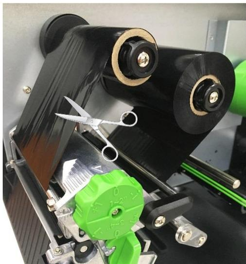
1. Coupez le film entre la plaque de guidage du film et l'axe de rembobinage du ruban.
