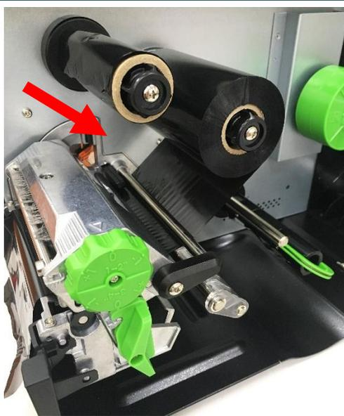
2. Faites coulisser le ruban pour le dégager de l'axe de rembobinage du ruban.
