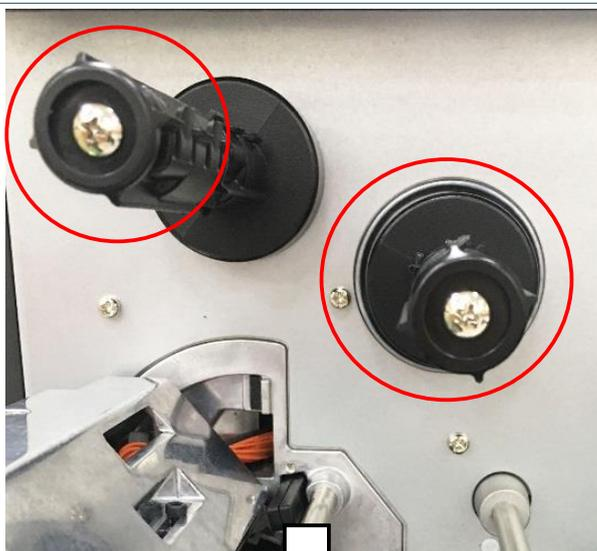
2. Installez le ruban sur l'axe d'alimentation du ruban et installez le mandrin du papier sur l'axe de rembobinage du ruban.
