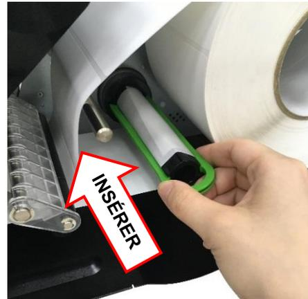
Remarque : L'axe de rembobinage du consommable permet également d'installer un rouleau de papier pour enrouler le consommable sur l'axe de rembobinage du consommable.
