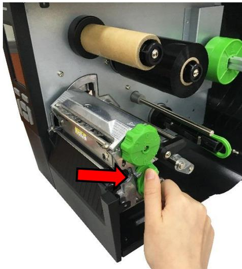
3. Poussez le levier de dégagement de la tête d'impression pour ouvrir le mécanisme de la tête d'impression.
