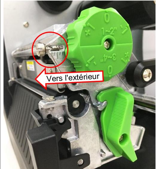
2. Si la molette de réglage de la tension du ruban a été positionnée sur le niveau du côté le plus à l'extérieur mais n'a pas résolu le problème de pli du ruban, veuillez ajuster la molette de réglage de la pression de la tête d'impression d'1 niveau et imprimez à nouveau l'étiquette pour vérifier si le pli a disparu.
