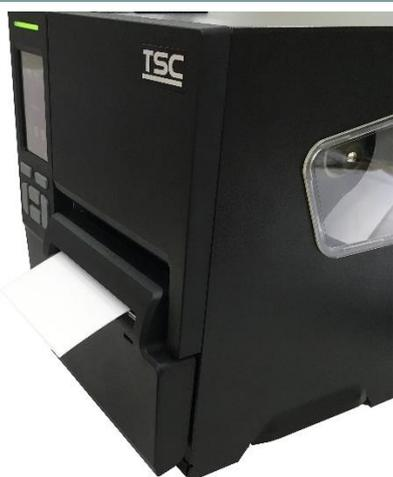
5. Fermez le mécanisme de la tête d'impression et appuyez sur le bouton AVANCER pour tester.
