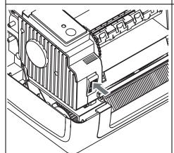
(4) Poussez le levier de libération de la (5) Passez le papier, côté impression vers le (6) Fermez le mécanisme de la tête tête d'impression pour ouvrir le mécanisme de la tête d'impression.
