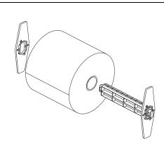
2) Insérez l'axe d'alimentation de consommable dans le rouleau de papier et utilisez deux languettes de fixation pour fixer le rouleau de papier au centre de l'axe.
