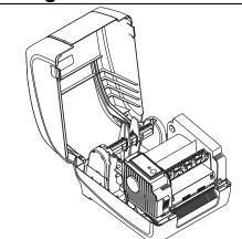
(1) Ouvrez le capot supérieur de l'imprimante en appuyant sur les languettes d'ouverture du capot supérieur situées de chaque côté de l'imprimante.
