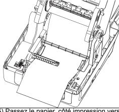
haut, dans les supports de consommables le capteur de consommables et placez le bord tête des étiquettes sur le cylindre d'entraînement. Déplacez les guides papier pour correspondre à la largeur du papier.
