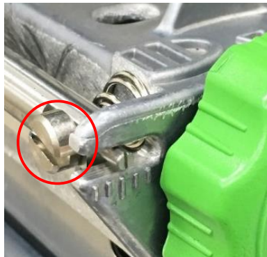
Perilla de ajuste de la tensión de la cinta
