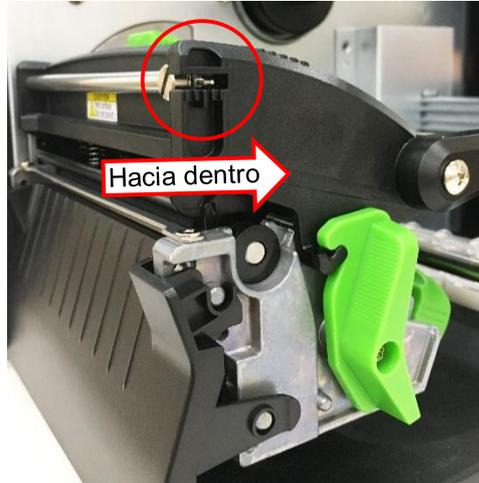
2. Si el mando de ajuste de la tensión de la cinta se ha colocado en el lado más interno pero no ha mejorado la arruga de la cinta, gire el mando de ajuste de la presión del cabezal de impresión 1 nivel e imprima la etiqueta de nuevo para comprobar si la arruga ha desaparecido.
