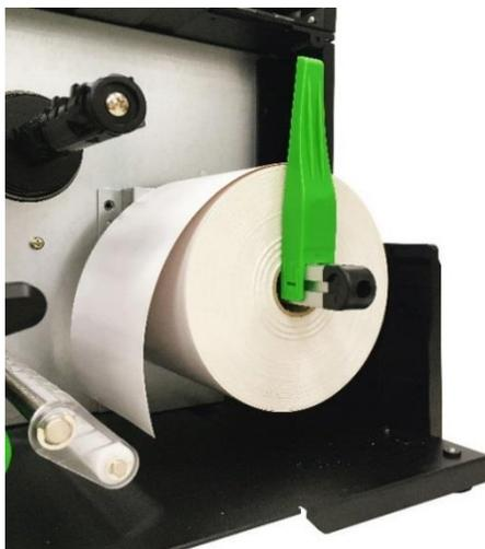
3. Coloque el rollo de soportes en el eje de suministro de etiquetas y utilice el protector del rollo de etiquetas para fijarlo.
