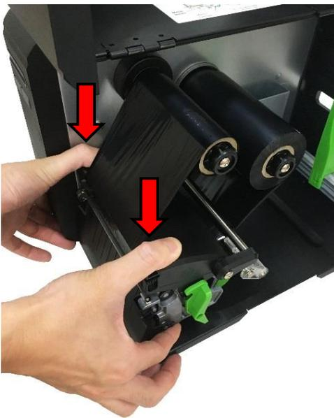
7. Cierre el mecanismo del cabezal de impresión presionando ambos lados de la palanca de liberación del cabezal de impresión.
