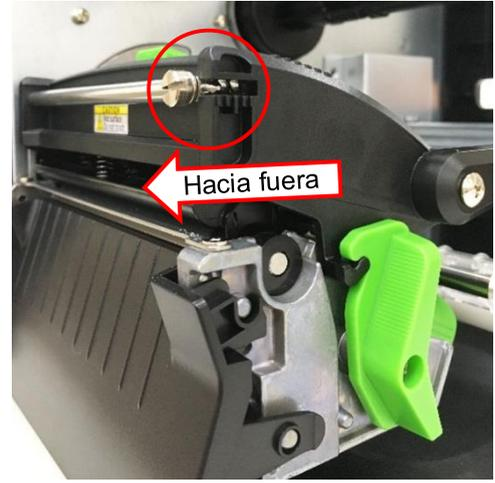
2. Si el mando de ajuste de la tensión de la cinta se ha colocado en el lado más externo pero no ha mejorado la arruga de la cinta, gire el mando de ajuste de la presión del cabezal de impresión 1 nivel e imprima la etiqueta de nuevo para comprobar si la arruga ha desaparecido.
