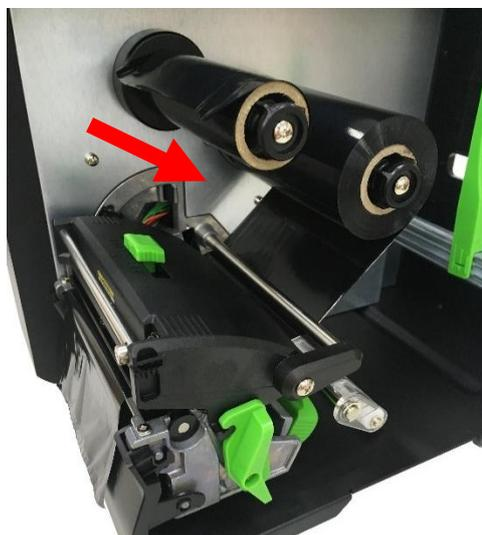
2. Deslice la cinta usada hacia afuera para liberarla del eje de rebobinado de la cinta.
