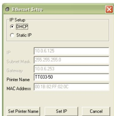
La dirección IP predeterminada se obtiene mediante DHCP. Para cambiar la configuración a una dirección IP estática, haga clic en el botón de opción "Static IP" (Dirección IP estática) y, a continuación, escriba la IP address (dirección IP), la máscara de subred y la puerta de enlace. Haga clic en "Set IP" (Establecer dirección IP) para aplicar la configuración.
