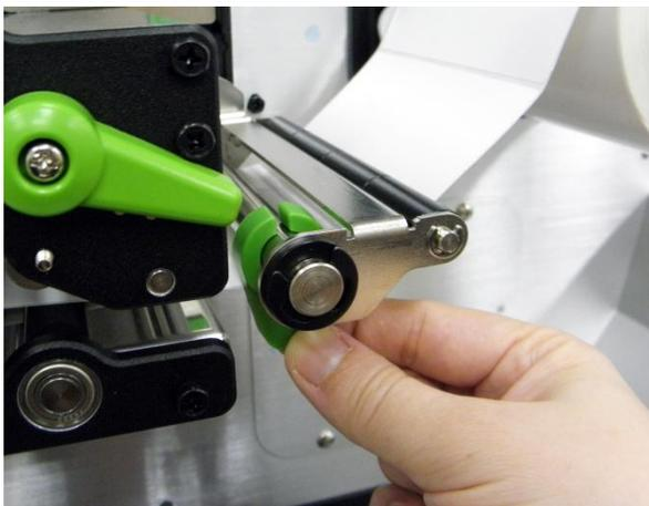
5. Ajuste la guía de etiquetas posterior (verde) para que encaje en la anchura de la etiqueta.
