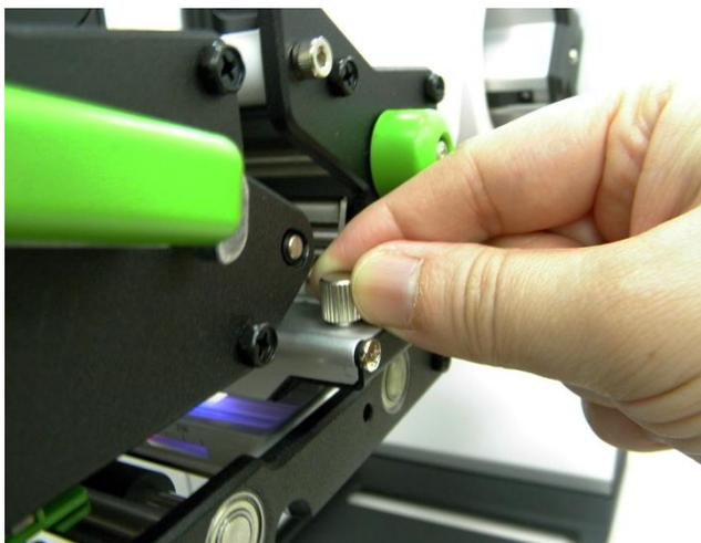
7. Mueva el sensor de soportes ajustando la perilla de ajuste de la posición del sensor de soportes. Asegúrese de que el sensor de espacios o de marcas negras se encuentra en la ubicación por la que pasa el espacio o marca negra del soporte para su detección.
