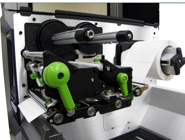
8. Cierre la palanca de liberación del cabezal de impresión y la palanca de liberación de la barra de guía.
