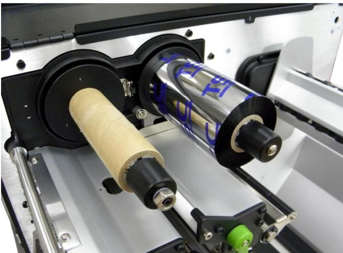
2. Instale la cinta y el núcleo de papel en el eje de suministro de la cinta y en el eje de rebobinado de la cinta.
