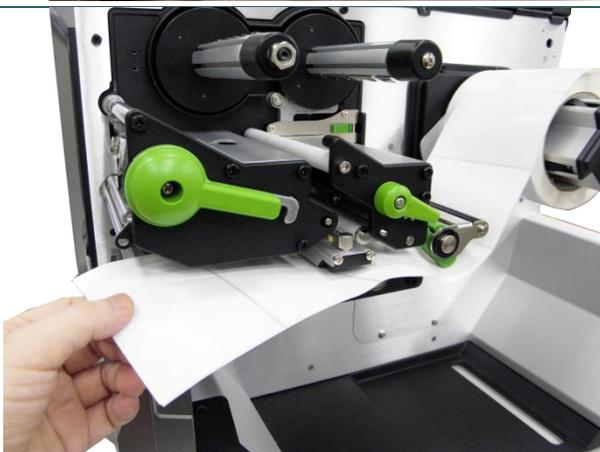
4. Tire del extremo delantero de la etiqueta a través de la barra de guía de soportes pasado el sensor de soportes y coloque el extremo principal de las etiquetas en el rodillo de la bandeja.
