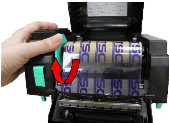
8. Gire el buje de rebobinado de la cinta hasta que la guía de plástico de la cinta esté perfectamente enrollada y la sección de color negro de dicha cinta cubra el cabezal de impresión.
