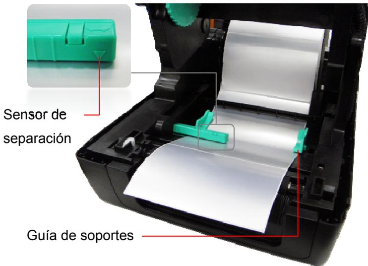
5. Inserte el papel, con el lado de impresión hacia arriba, a través de la barra del soporte y el sensor de soportes, y coloque el borde de cabecera de las etiquetas en el rodillo de la bandeja. Mueva las guías de los soportes para fijar el ancho de la etiqueta.
