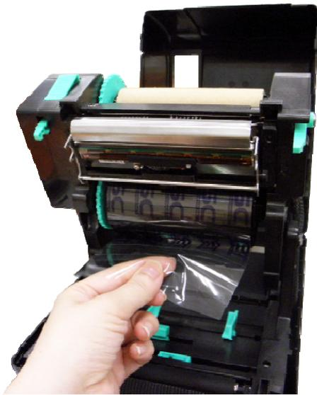
7. Tire del inicio de la cinta a través del cabezal de impresión y pegue dicho inicio en el núcleo de papel de rebobinado de la cinta.
