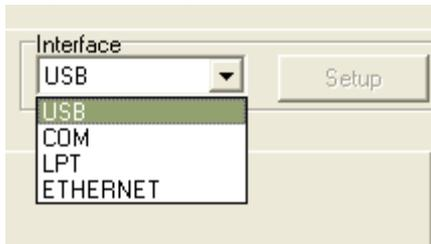
5. Haga clic en el botón “Ethernet Setup” (Configuración de Ethernet) del grupo “Printer Function” (Función de impresora) de la ficha Printer Configuration (Configuración de impresora) para definir la dirección IP, la máscara de subred y la puerta de enlace para la función Ethernet integrada.
