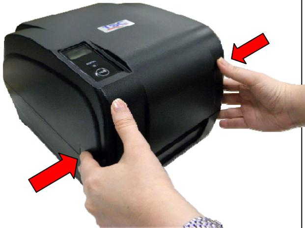
1. Abra la tapa superior de la impresora presionando las pestañas de apertura de dicha tapa situadas a cada lado de la impresora.
