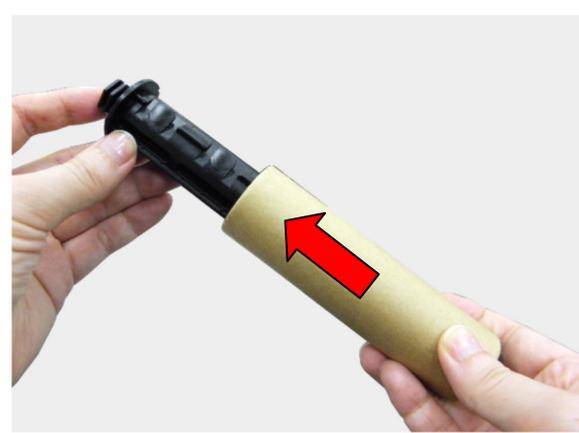
2. Inserte el núcleo de papel en el eje de rebobinado de la cinta.
