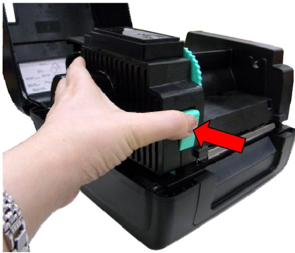
4. Presione el botón de liberación del cabezal de impresión para abrir el mecanismo de dicho cabezal.
