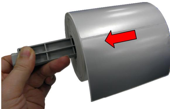
2. Inserte el rollo de papel en el eje de suministro de soportes y utilice dos pestañas de fijación para asegurar dicho rollo en el centro del eje. (Si el ancho del papel que es de 10,16 cm (4 pulgadas), puede quitar las pestañas de fijación del eje de suministro).
