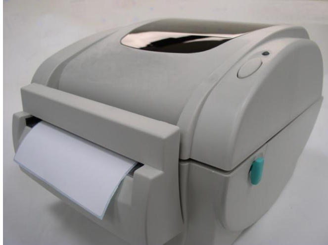
Fig. 19 Installation des étiquettes en mode de découpage (cutter) terminée
