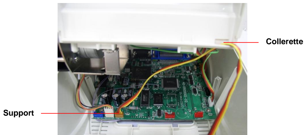
Fig.16 Organisation des fils couplés du module de découpage
