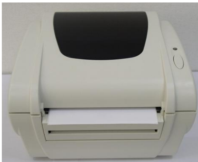
Fig. 8 Fermeture complète du capot supérieur
