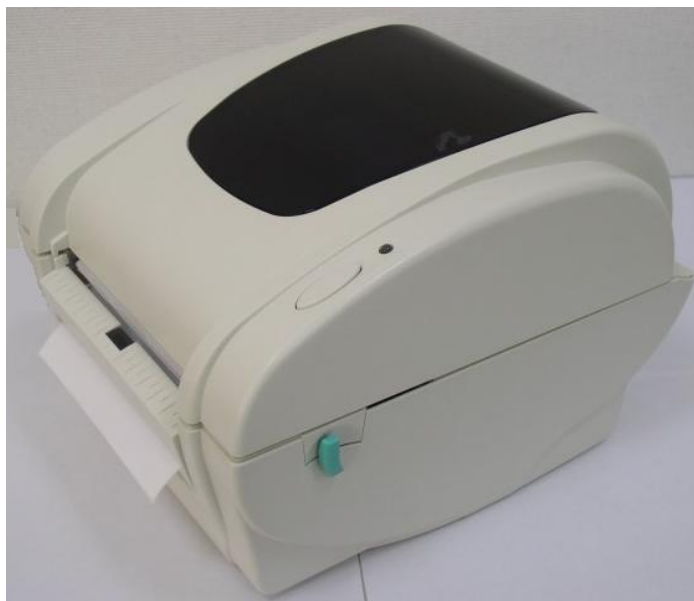
Fig. 11 Chargement complet des étiquettes en mode pré-décollage
