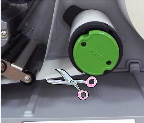
1. Coupez le liner entre le cylindre de pré-décollage et l'axe de rembobinage interne.
