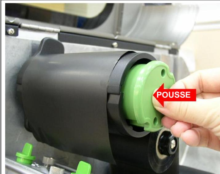
2. Poussez le bouton de libération du film pour dégager le film de l'axe de rembobinage.
