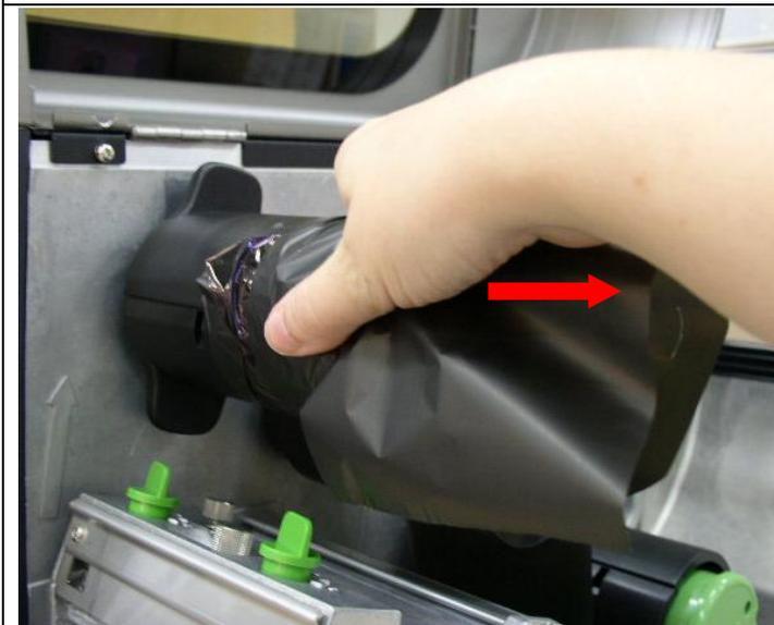
3. Puis faites glisser le film hors de l'axe de rembobinage.
