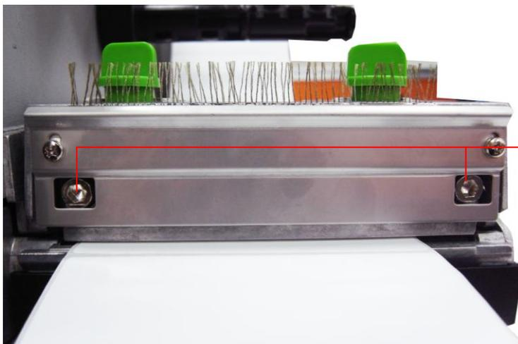
Molettes de réglage de la ligne d'impression de la tête d'impression
