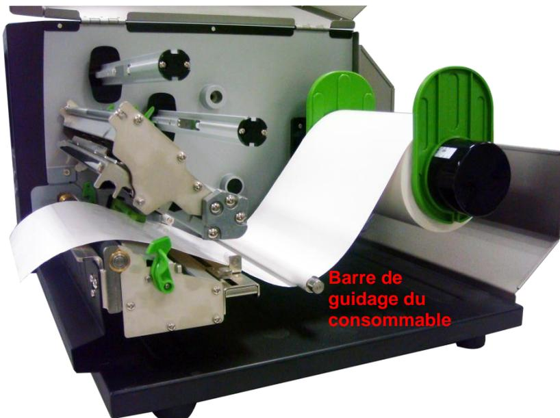
6. Le capteur de consommable peut être déplacé. Assurez-vous que l'espacement ou la marque noire se trouve à l'endroit où le consommable à espacement/à marque noire sera détecté par le capteur.
