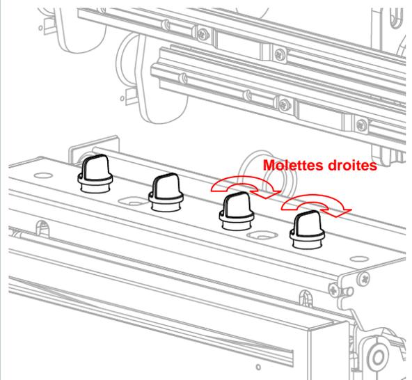
La molette de réglage de la pression de la tête d'impression présente 5 niveaux de réglage. Un réglage dans le sens des aiguilles d'une montre permet d'augmenter la pression de la tête d'impression. Un réglage dans le sens inverse permet de diminuer la pression de la tête d'impression.
