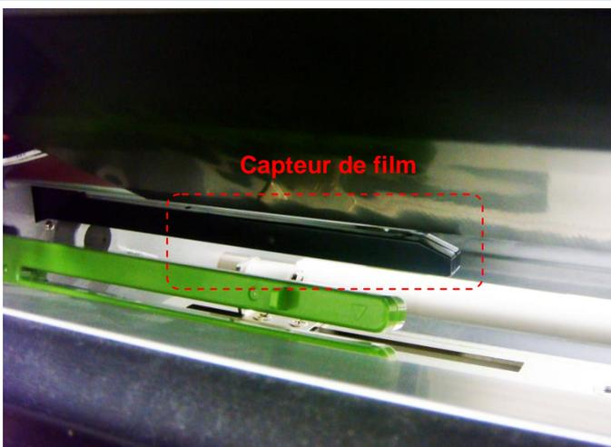
3. Faites passer le film dans la fente du capteur de film, puis dans l'ouverture entre la tête d'impression et le cylindre d'entraînement.
