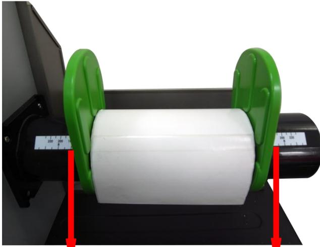
4. Placez le rouleau du média sur l'axe d'alimentation des étiquettes. Remplacez la barre de retenue du rouleau d'étiquettes. Assurez-vous que la position de la barre de retenue des rouleaux d'étiquettes de chaque côté est la même que la longueur de l'étiquette. Veuillez vérifier que les graduations des bords extérieurs sont toutes les deux à proximité de la largeur de l'étiquette.
