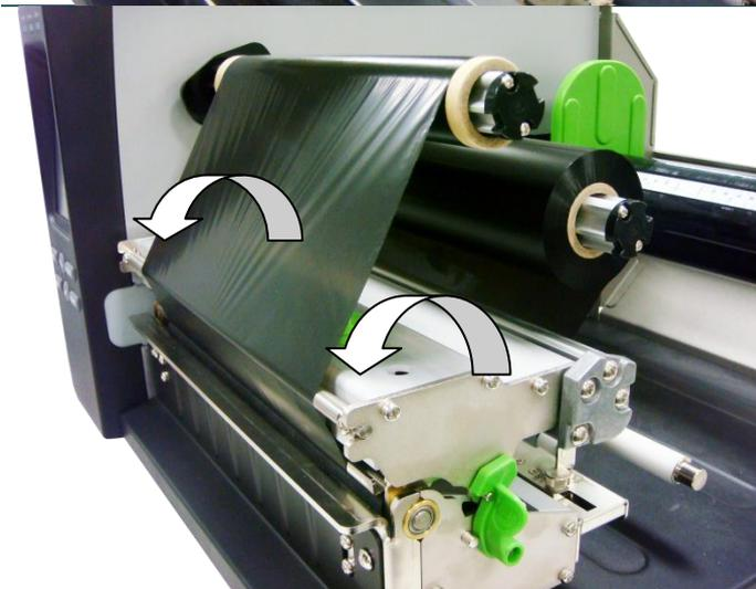
6. Fermez le mécanisme de la tête d'impression en s'assurant du bon engagement des loquets.
