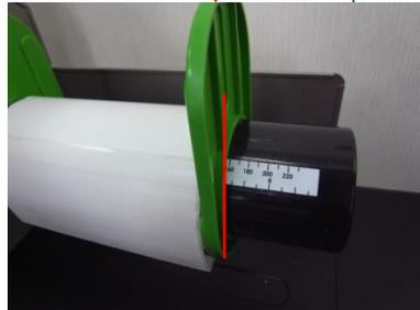
5. Tirez le bord avant du rouleau d'étiquettes vers l'avant, au travers de la barre de guidage du consommable, du capteur de consommable (vert), puis placez-le sur le cylindre d'entraînement.
