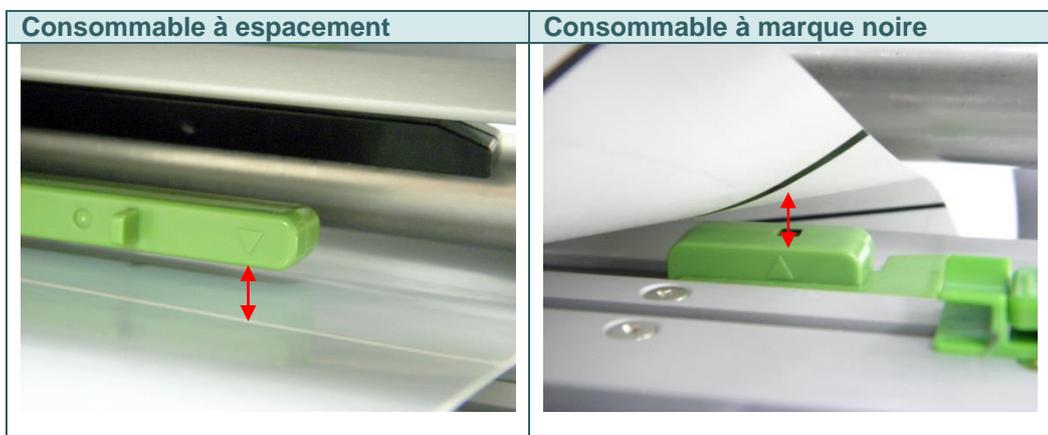
7. Desserrez la vis fixe pour régler le guide des étiquettes pour qu'il corresponde à la largeur des étiquettes. Vissez la vis fixe pour verrouiller le guide de l'étiquette.
