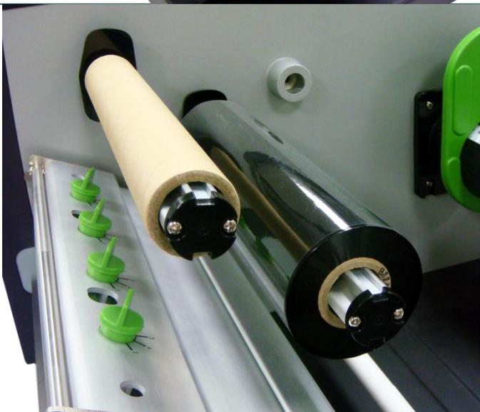
2. Installez le ruban et le mandrin papier sur l'axe d'alimentation du ruban et l'axe de rembobinage du ruban. **Assurez-vous que le ruban et le mandrin papier sont au centre de la bobine.** (Vous pouvez vous référer à la règle sur les axes.)
