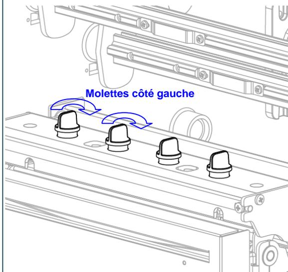
La molette de réglage de la pression de la tête d'impression présente 5 niveaux de réglage. Un réglage dans le sens des aiguilles d'une montre permet d'augmenter la pression de la tête d'impression. Un réglage dans le sens inverse permet de diminuer la pression de la tête d'impression.
