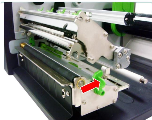
1. Soulevez la poignée pour ouvrir le couvercle latéral droit de l'imprimante. Poussez le levier de libération de la tête d'impression pour ouvrir le mécanisme de la tête d'impression.
