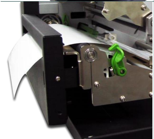
3. Insérez le papier consommable à travers l'ouverture pour papier du module de découpage.
