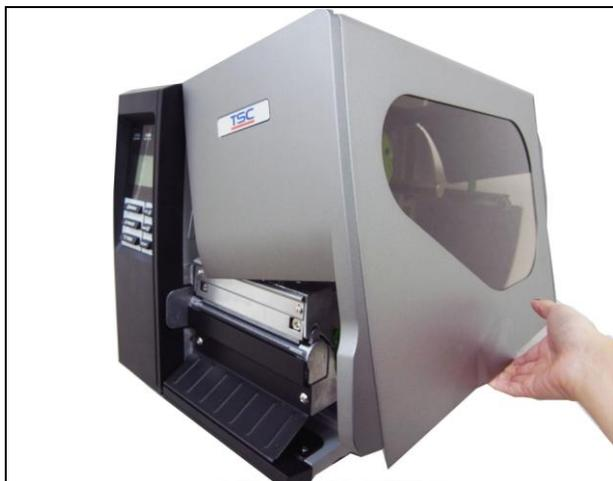
1. Abra la cubierta lateral derecha de la impresora.
