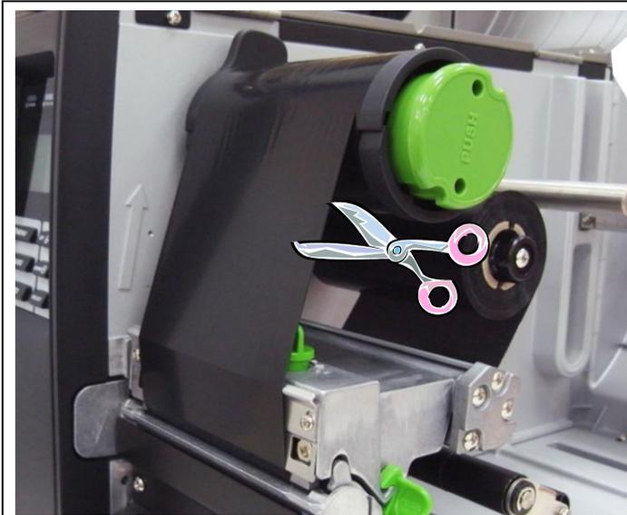
1. Corte la cinta entre la placa de guía de la cinta y el eje de rebobinado de la cinta.
