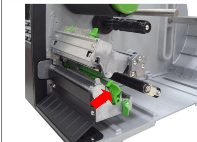
2. Presione la palanca de liberación del cabezal de impresión para abrir el mecanismo de dicho cabezal.
