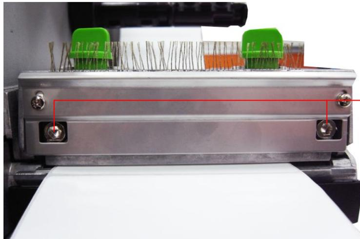
Perillas de ajuste de la línea de quemado del cabezal de impresión
