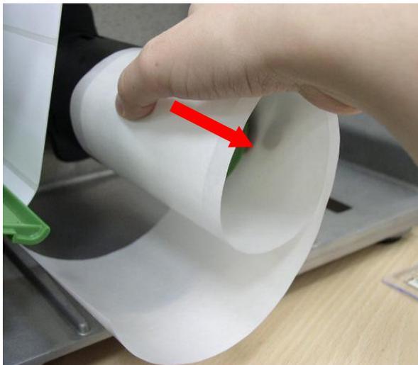
3. A continuación, retire el alineador del eje de rebobinado interno.
