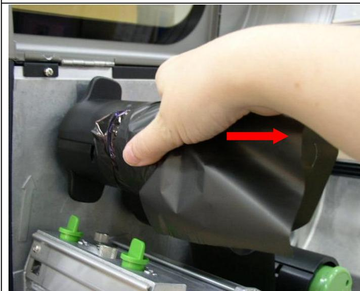
3. A continuación, retire la cinta del eje de rebobinado de la cinta.
