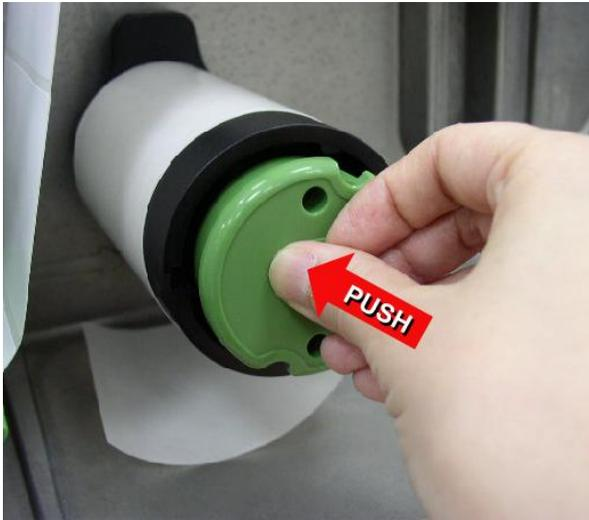
2. Presione el botón de liberación del alineador para liberar el alineador del eje de rebobinado interno.
