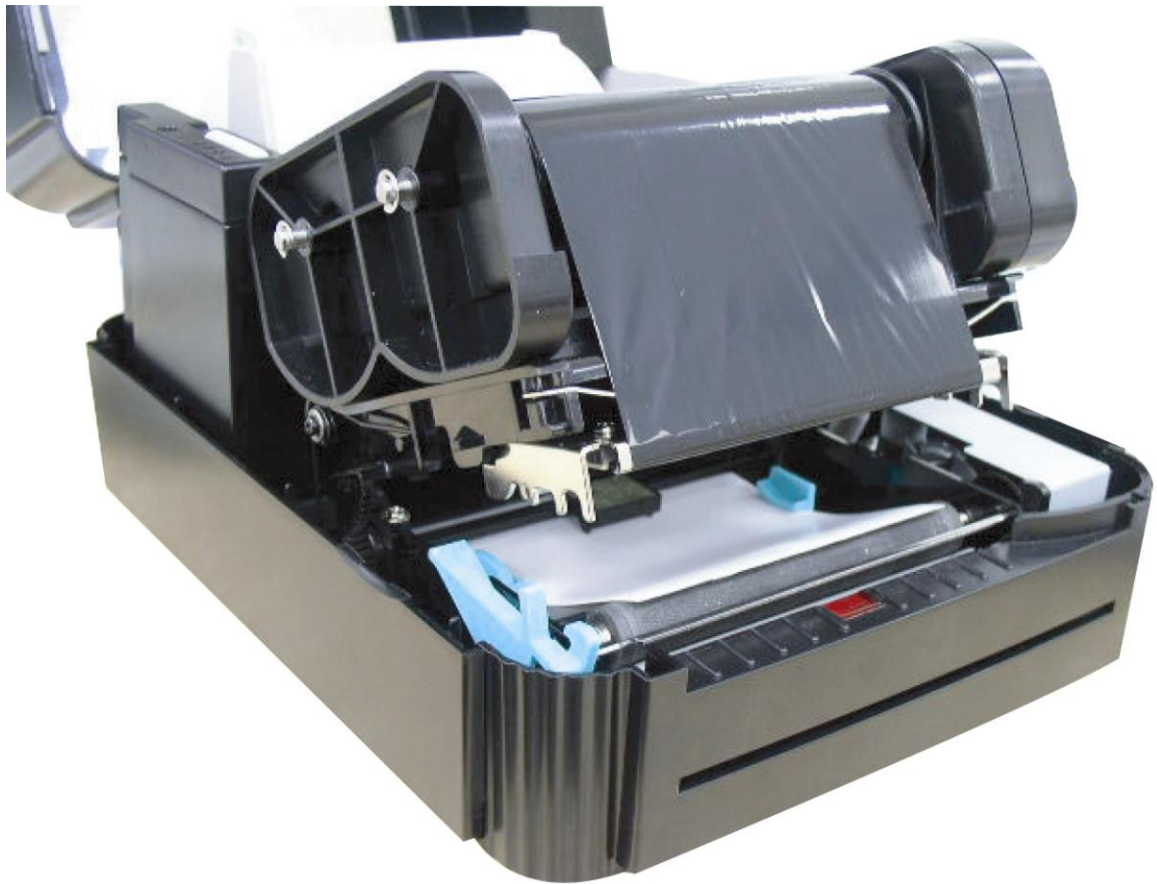
Figura 10. Instalación del soporte de etiquetas y de la cinta de transferencia térmica
