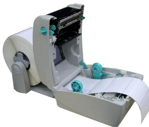
6. Mueva las guías de los soportes para ajustar el ancho de las etiquetas girando el mando de ajuste de la guía.
