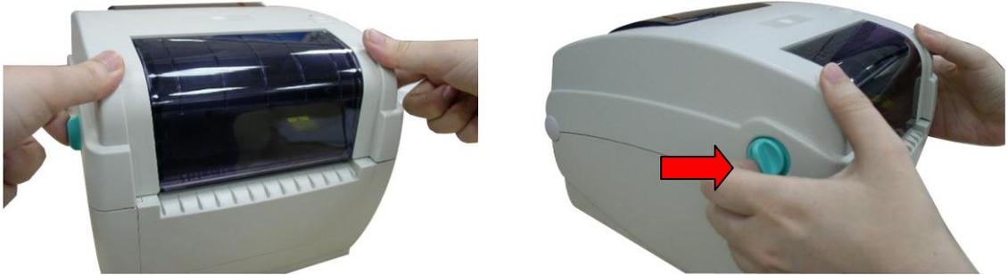
2. Un soporte de la tapa superior situado en la parte posterior de la impresora se enganchará con la tapa inferior interior para mantener abierta la tapa superior de la impresora.
