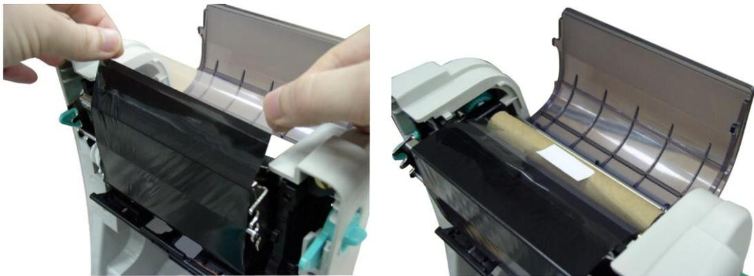
6. Gire el engranaje de rebobinado de la cinta hasta que la guía de plástico de la cinta esté perfectamente enrollada y la sección de color negro de dicha cinta cubra el cabezal de impresión. Cierre la tapa de acceso a la cinta y la tapa superior.
