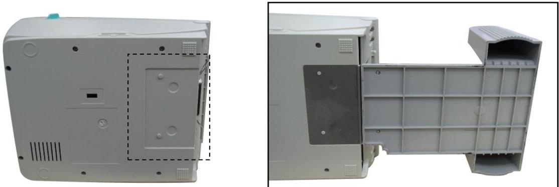
2. Inserte un eje de etiquetas de 7,62 cm (3 pulgadas) en un rollo de papel. A continuación, instálelo en el soporte para rollo de papel externo.
