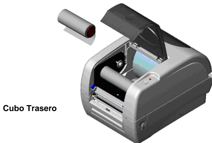
Figura 5. Instalación de la cinta (II)
