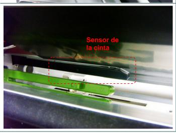
Pase la cinta por la ranura del sensor de la cinta y, a continuación, por el espacio abierto entre el cabezal de impresión y la bandeja.
