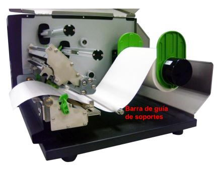
6. La posición del sensor de soportes es movible. Asegúrese de que el espaciado o la marca negra se encuentran la ubicación por la que pasará el espaciado de soportes o la marca negra para su detección.
