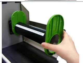
Quite la protección de un rollo de etiquetas del eje de etiquetas.
