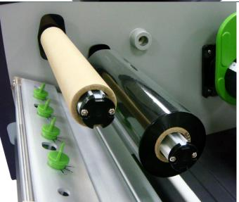
Instale la cinta y el núcleo de papel en el eje de suministro de la cinta y en el eje de rebobinado de la cinta.
