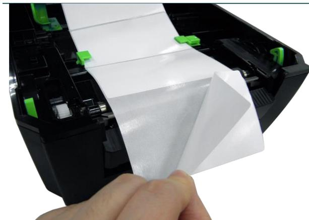
4. Abra la tapa superior con cuidado. Tire de la etiqueta a través de la parte frontal de la impresora y quite algunas etiquetas para dejar solamente el revestimiento.
