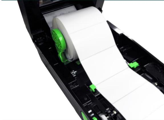
1. Consulte la sección 3.3.1 para insertar el papel, con la cara de impresión hacia arriba, a través de la guía de papel y páselo sobre el rodillo.
