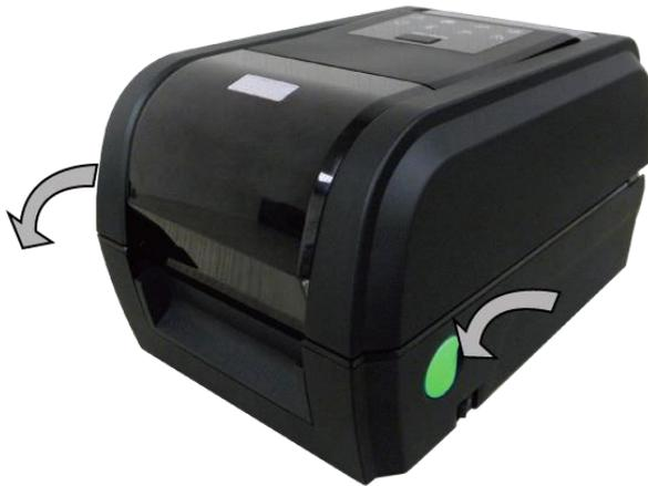
1. Abra la tapa superior de la impresora tirando de las lengüetas situadas a cada lado de la impresora hacia la parte delantera de esta y, a continuación, levante dicha tapa hasta el ángulo máximo de apertura.
