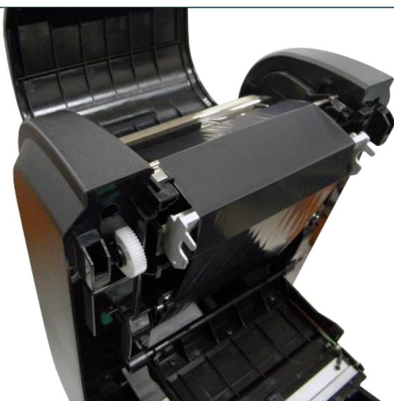
7. Pegue la cinta en el núcleo del papel de rebobinado de la cinta.
