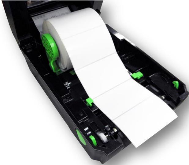
4. Coloque el papel, con el lado de impresión hacia arriba, a través del sensor de soportes y coloque el borde de cabecera de las etiquetas en el rodillo de la bandeja.
