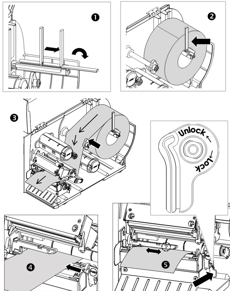
Loading Ribbon/安装碳带/安装碳带/ローディングリボン/Загрузочная лента/
