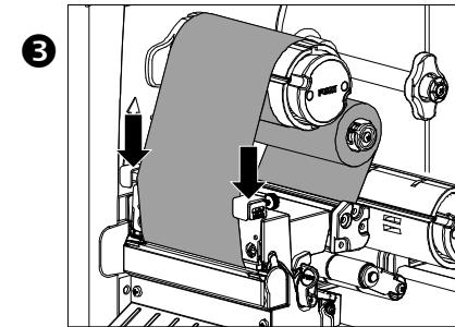
Remove Used Ribbon/移除碳带/移除碳带/中古リボンを取り外す/ Удалить использованную
