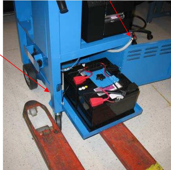
Pour faciliter le remplacement des batteries, commencer par déposer le châssis de batteries. (Voir la section 6.1.) Une fois le châssis de batteries déposé hors du chariot, le placer sur un établi approprié (ne jamais intervenir sur le châssis de batteries lorsqu'il se trouve sur la fourche du transpalette).
