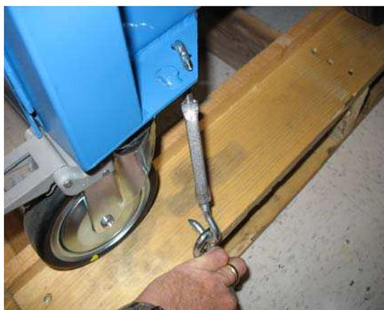
Débloquer le frein de roulette. Saisir les poignées de type « guidon de bicyclette », faire descendre le chariot par les rampes et l'amener à l'endroit souhaité. Remettre les rampes de déchargement sur la palette et entreposer la palette ainsi que les tendeurs pour une utilisation future.
