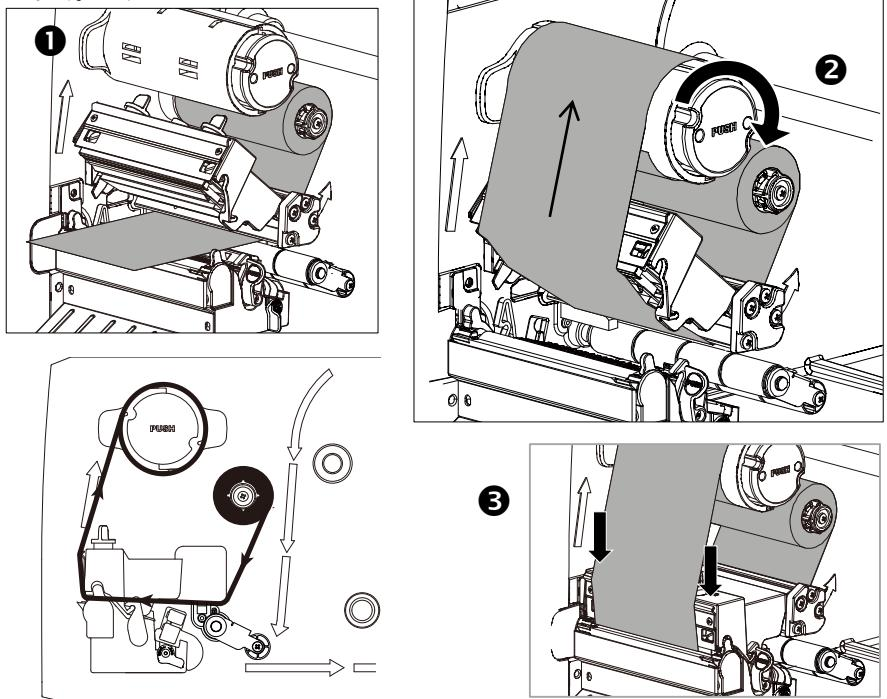
Remove Used Ribbon/移除碳带/移除碳带/中古リボンを取り外す/ Удалить использованную
