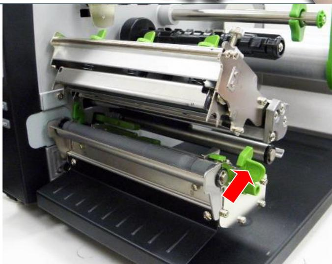
2. Presione la palanca de liberación del cabezal de impresión para abrir el mecanismo de dicho cabezal.
