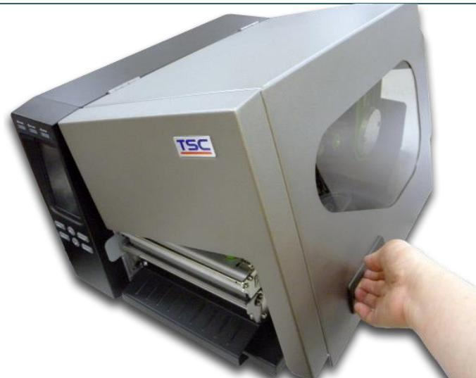
1. Levante el asa para abrir la cubierta lateral derecha de la impresora.
