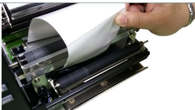
4. Introduzca la etiqueta por la ranura de la tapa de separación y el rodillo de la bandeja. Tenga en cuenta la dirección de la etiqueta (la cara imprimible orientada hacia arriba).
