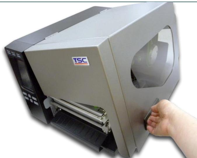
1. Levante el asa para abrir la cubierta lateral derecha de la impresora.
