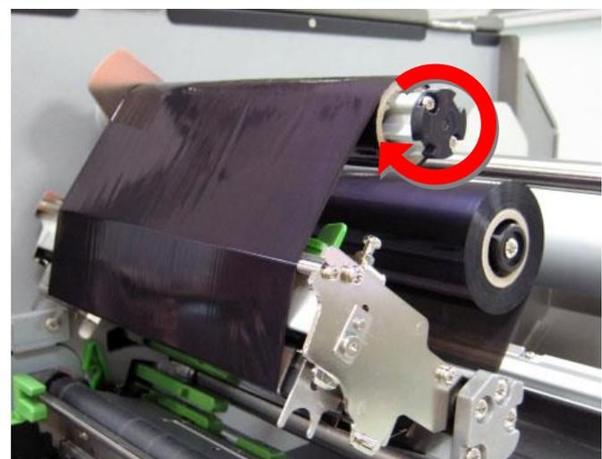
6. Gire la cinta en el sentido de las agujas del reloj de 3 a 5 círculos en el eje de rebobinado de la cinta hasta que quede plana y extendida.
