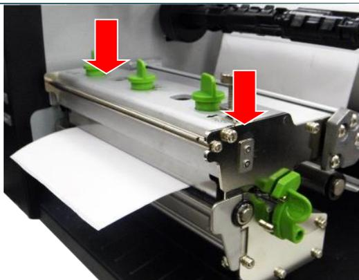
8. Cierre el mecanismo del cabezal de impresión. Asegúrese de que los seguros están perfectamente accionados.
