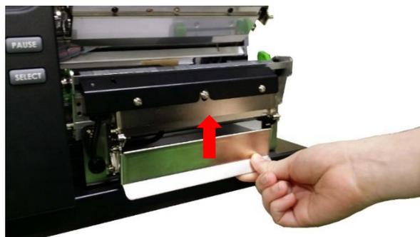
3. Tire de la tapa inferior del cabezal de impresión hacia arriba como se indica en la imagen.
