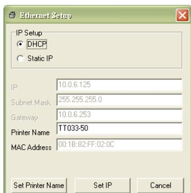
La dirección IP predeterminada se obtiene mediante DHCP. Para cambiar la configuración a una dirección IP estática, haga clic en el botón de opción "Static IP" (Dirección IP estática) y, a continuación, escriba la dirección IP, la máscara de subred y la puerta de enlace. Haga clic en "Set IP" (Establecer dirección IP) para aplicar la configuración.
