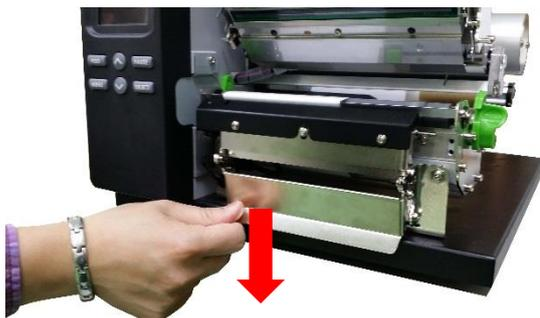
6. Tire de la tapa inferior hacia abajo para cerrar el cabezal de impresión.
