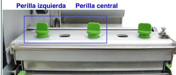
La perilla de regulación de presión del cabezal de impresión cuenta con 5 niveles de ajuste. El ajuste de la dirección en el sentido de las agujas del reloj se realiza para aumentar la presión del cabezal de impresión. El ajuste en sentido contrario a las agujas del reloj puede disminuir la presión del cabezal de impresión.
