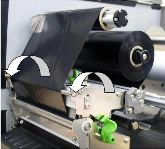
7. Cierre el mecanismo del cabezal de impresión asegurándose de que los cierres estén situados de forma segura.
