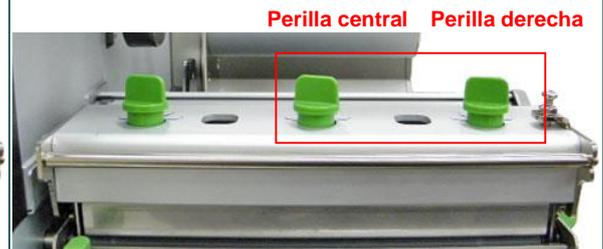
La perilla de regulación de presión del cabezal de impresión cuenta con 5 niveles de ajuste. El ajuste de la dirección en el sentido de las agujas del reloj se realiza para aumentar la presión del cabezal de impresión. El ajuste en sentido contrario a las agujas del reloj puede disminuir la presión del cabezal de impresión.
