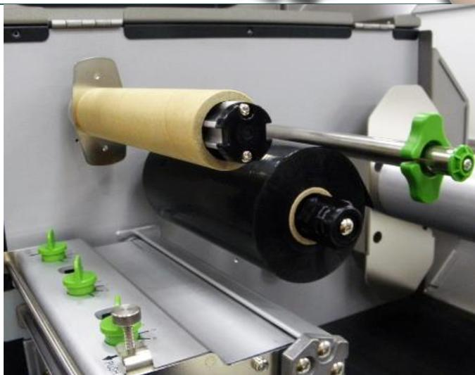
2. Instale la cinta y el núcleo de papel en el eje de suministro de la cinta y en el eje de rebobinado de la cinta.
