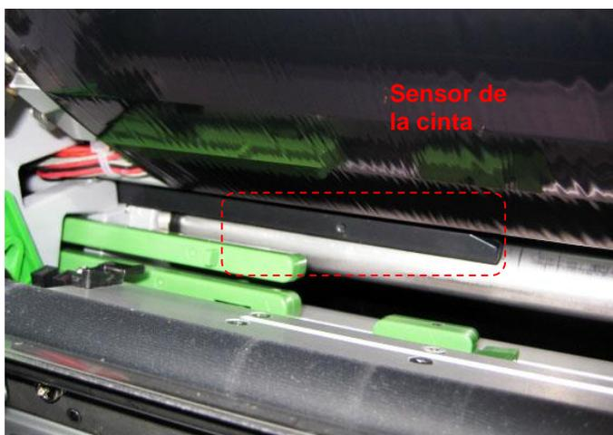
4. Pase la cinta por la ranura del sensor de la cinta y, a continuación, por el espacio abierto entre el cabezal de impresión y la bandeja.
