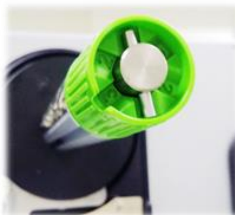
Eje de suministro de la cinta Tensión n.º 1
