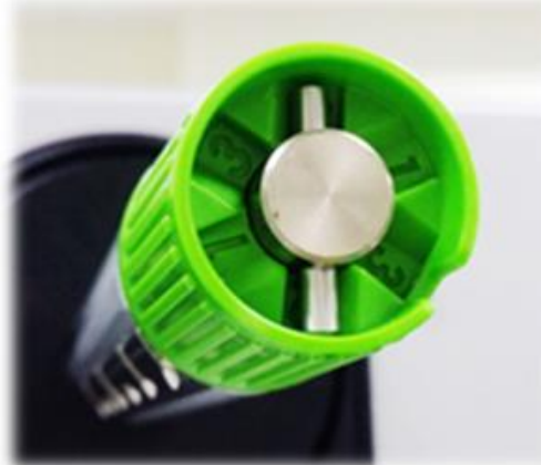
Eje de suministro de la cinta Tensión n.º 2
