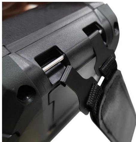
1. Verriegeln Sie die Gürtelklemme am unteren Teil des Druckers.
