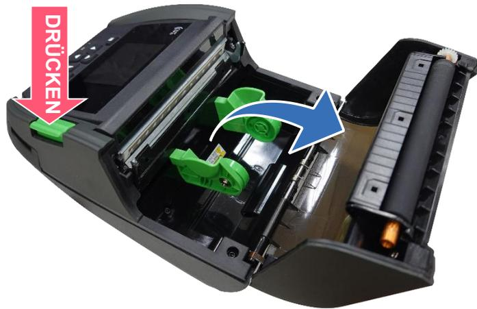
1. Öffnen Sie die Druckermedienabdeckung durch Drücken des Medienabdeckung-Freigabeknopfs.
