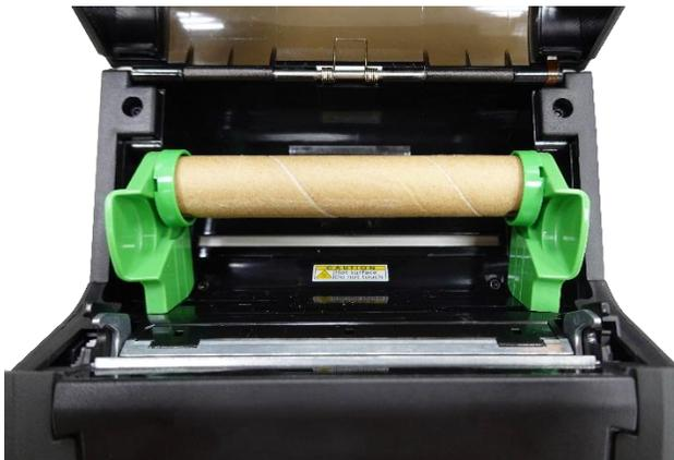
3. Installieren Sie die Etikettenrolle zum Halten des Medienhalters.
