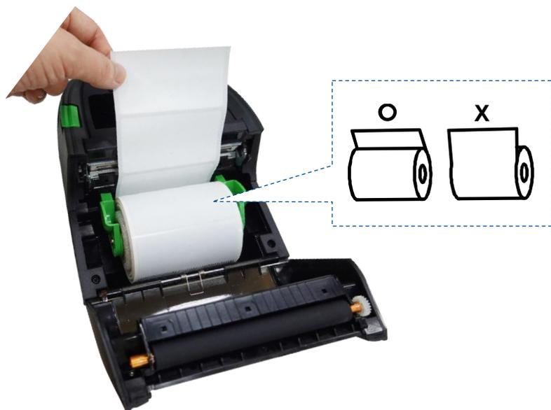
3. Legen Sie die Rolle zwischen die Medienhalter, lassen Sie die beiden Lager in den Rollenkern greifen. Platzieren Sie das Papier mit der Druckseite nach oben und ziehen Sie genügend Papier über den Druckkopf.
