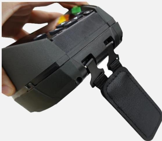
2. Drücken Sie den Haken der Gürtelklemme wie abgebildet in die Schienen am unteren Teil des Druckers. Der Drucker kann an den Gurt gehängt werden.
