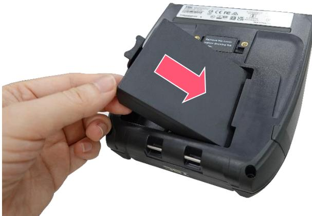
1. Öffnen Sie die obere Abdeckung des Druckers. Setzen Sie die rechte Seite zur Installation des Akkus an der Rückseite des Druckers ein.
