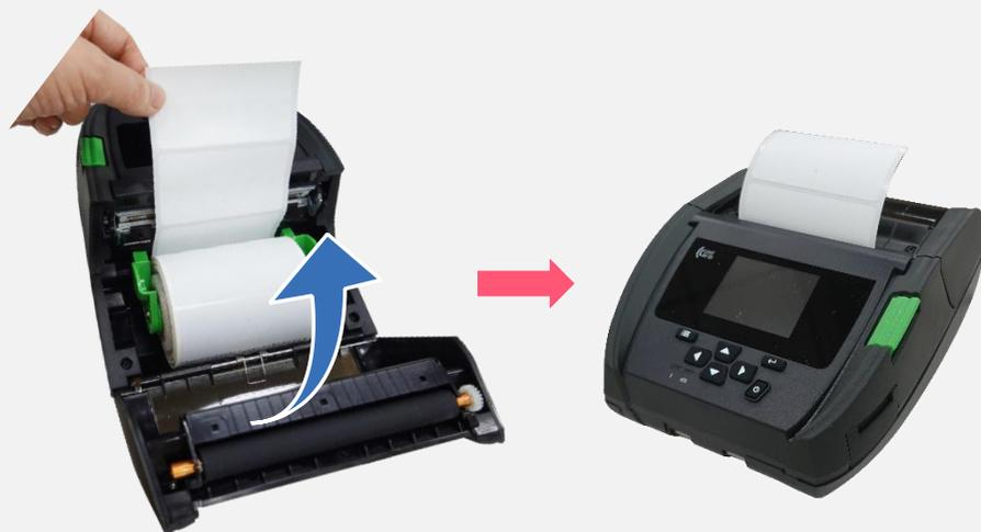
4. Drücken Sie beide Seiten der Medienabdeckung zum Schließen; stellen Sie sicher, dass die Medienabdeckung richtig geschlossen ist.
