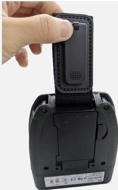
2. Presione el gancho de la pinza para cinturón en las barras de la impresora inferior como se muestra en la imagen. La impresora se puede colgar en el cinturón.
