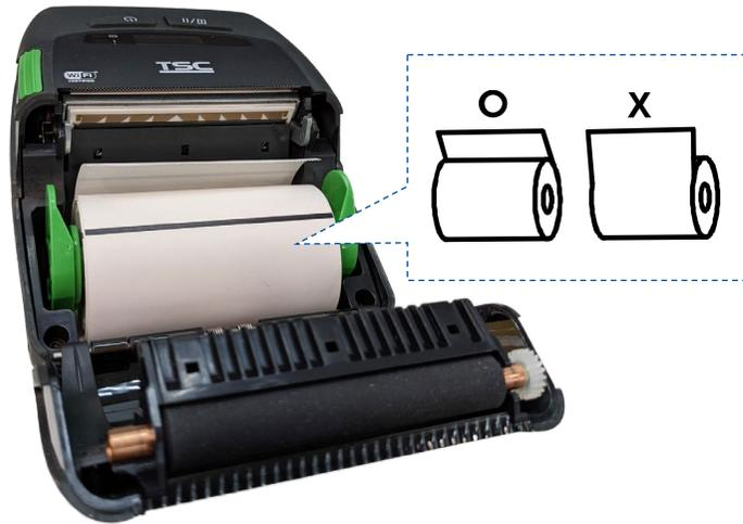
3. Coloque el rollo entre las monturas de soportes y ciérrelas en el núcleo. Coloque el papel, con el lado de impresión hacia arriba y extraiga suficiente papel sobre el cabezal impresión.
