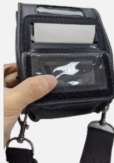
**4.** Abra la cubierta exterior para comprobar. La cubierta exterior debe estar abierta y fijada durante la impresión.
