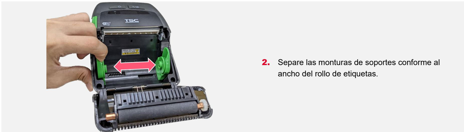
2. Separe las monturas de soportes conforme al ancho del rollo de etiquetas.
