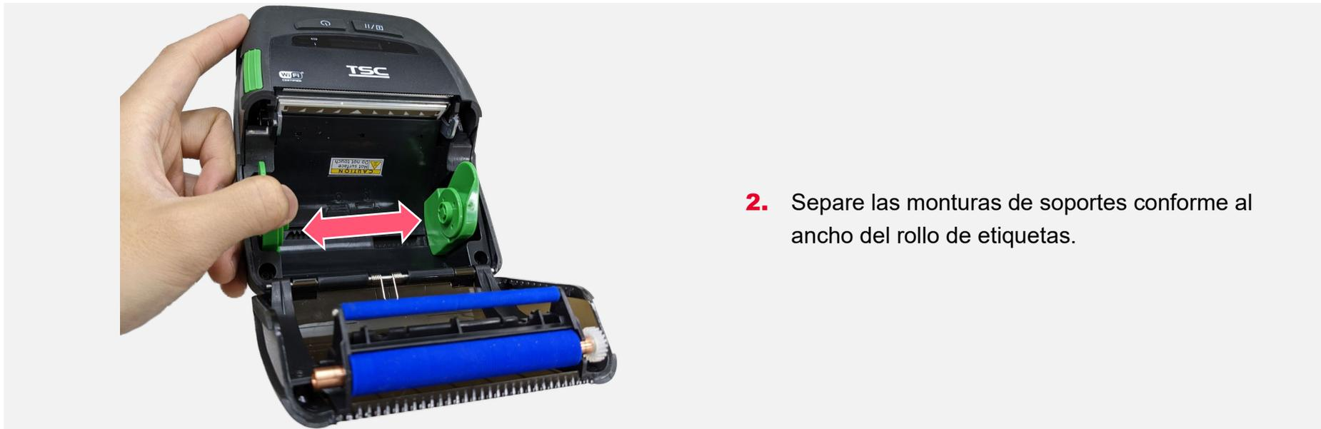
2. Separe las monturas de soportes conforme al ancho del rollo de etiquetas.
