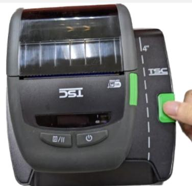
6. Cuando la batería se haya cargado completamente, el indicador LED de la impresora se apagará. Presione el botón para desbloquear la hebilla.
