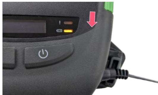
3. Durante la carga, el indicador LED de estado de la batería de la impresora se ilumina en ámbar de forma permanente. Cuando la batería se haya cargado completamente, el indicador LED de la impresora se apagará. La carga se detendrá automáticamente después de que la batería esté completamente cargada.
