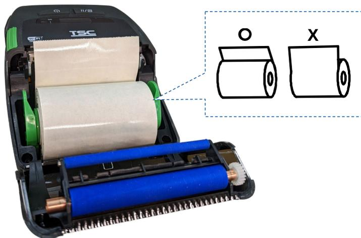
3. Coloque el rollo entre las monturas de soportes y ciérrelas en el núcleo. Coloque el papel, con el lado de impresión hacia arriba y extraiga suficiente papel sobre el cabezal impresión.
