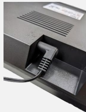
4. Enchufe el adaptador de alimentación del cargador a una toma de corriente con conexión una tierra adecuada y enchufe el conector del cargador a una toma de CC del cargador de batería.
