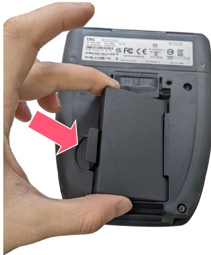
1. Coloque la batería bajo el lado derecho de la ranura de la batería.
