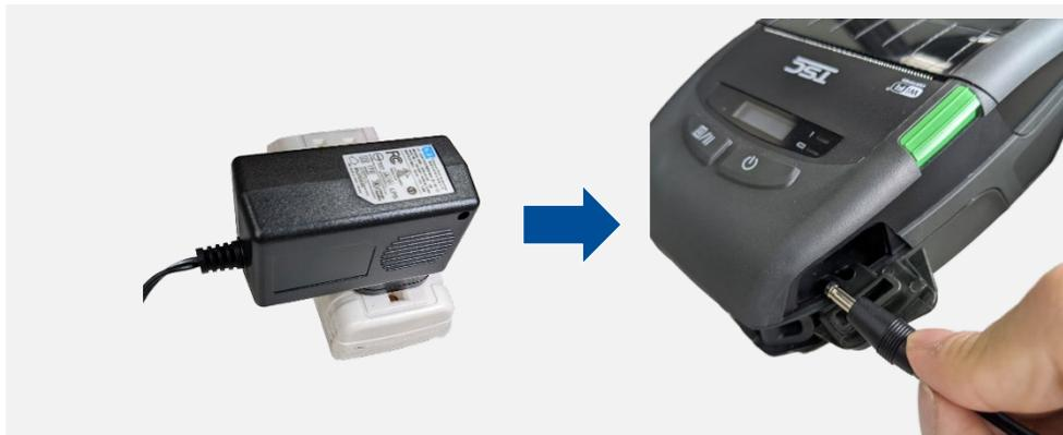
2. Conecte el cable de alimentación a la toma de corriente y al enchufe.
