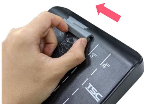
1. Instale la carcasa de transferencia en el gancho de fijación.
