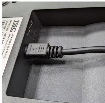
5. Enchufe el adaptador de alimentación del cargador a una toma de corriente con conexión una tierra adecuada y enchufe el conector del cargador a una toma de CC del cargador de batería.
