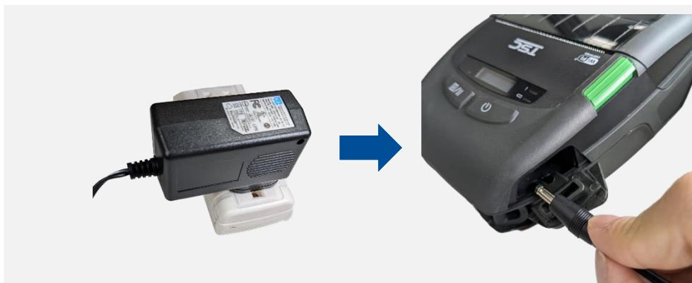
2. Collegare il cavo di alimentazione al jack di alimentazione e alla presa di corrente.
