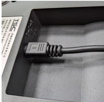
5. Inserire l'adattatore di alimentazione del caricabatterie a una presa con adeguata messa a terra e collegare il connettore del caricabatterie a una presa CC del caricabatterie.
