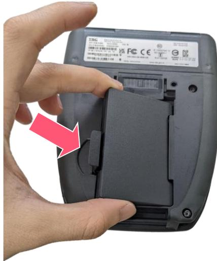
1. Collocare la batteria sotto il lato destro dell'alloggio batteria.
