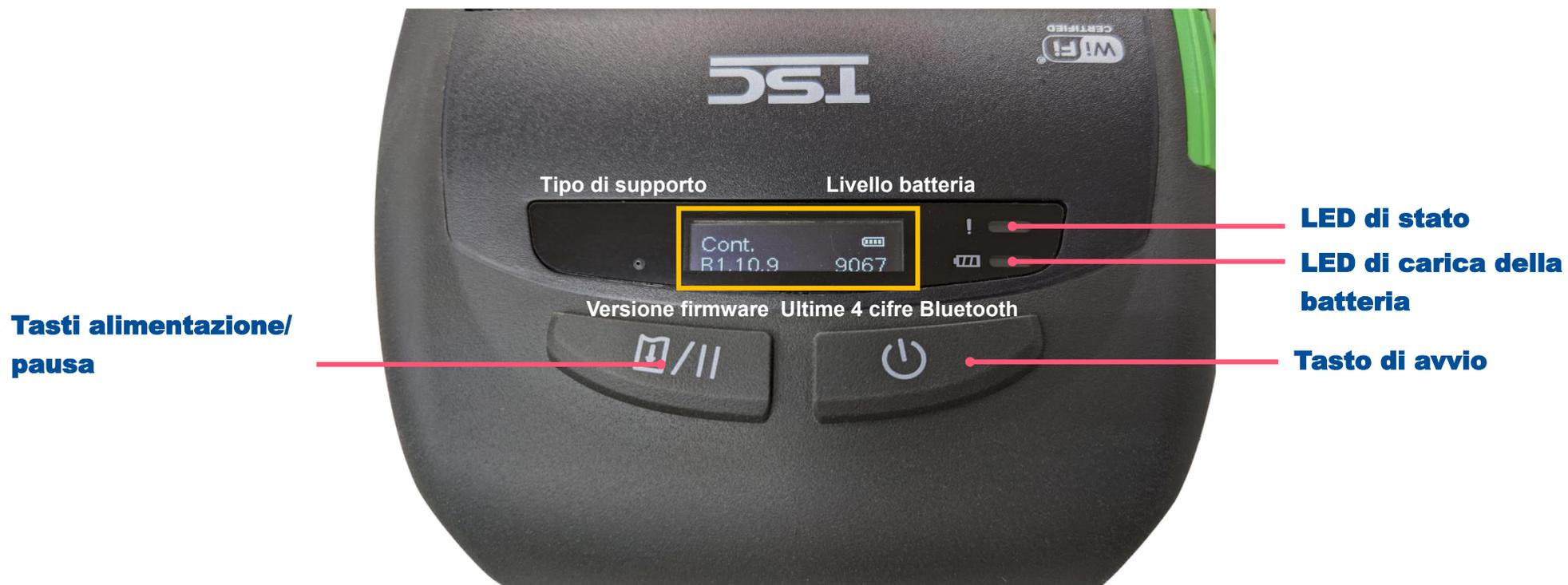
Quando il Wi-Fi è connesso, l'indirizzo IP sostituisce la versione firmware e il numero Bluetooth sul display.
