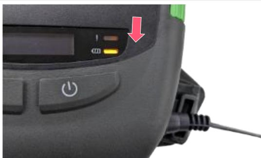
3. Durante la carica, il LED di stato della batteria sulla stampante diventa giallo fisso. Dopo la carica completa, il LED della stampante si spegne. Cessa di caricarsi automaticamente dopo che la batteria è completamente carica.
