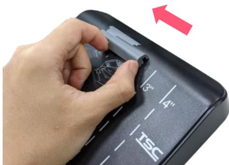
1. Installare la scatola di trasferimento sul gancio di fissaggio.
