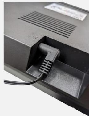
4. Inserire l'adattatore di alimentazione del caricabatterie a una presa con adeguata messa a terra e collegare il connettore del caricabatterie a una presa CC del caricabatterie.
