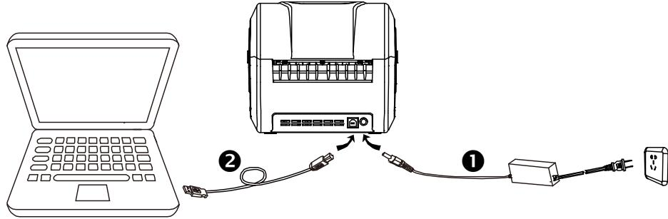
Turn on the Power/開啟電源/开启电源/電源を入れる/Включение принтера/Schalte den Strom an/Allumer l'appareil/Conectar la alimentación/Accendi il potere/Tekan Tombol Power/تشغيل الطاقة
