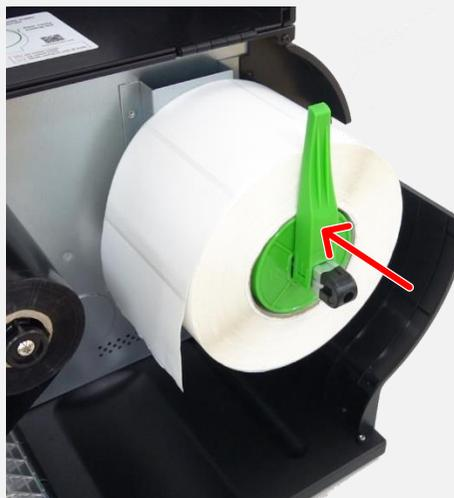
4. Поднимите ограничитель рулона носителя вверх и сдвиньте его так, чтобы он соответствовал ширине рулона этикеток
