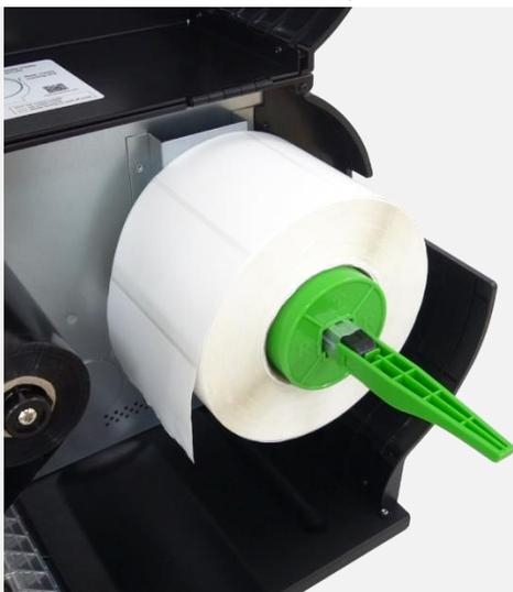
3. Поместите рулон носителя на вал подачи носителя (с насадками для 3-дюймового сердечника) и продвиньте его к концу вала.
