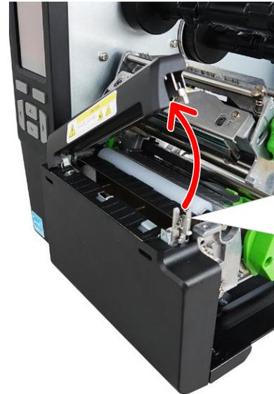
2. Откройте верхнюю планку затвора модуля резака для носителя без подложки (или отрывного).
