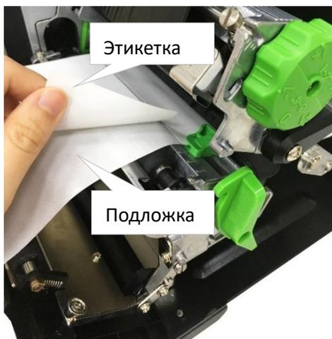
7. Отпустите рычаг, чтобы открыть печатающую головку после калибровки. Отпустите рычаг модуля снятия защитной пленки.
