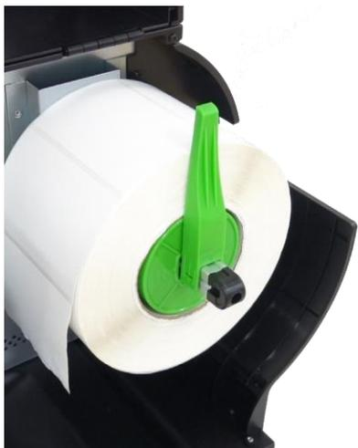
1. Откройте крышку отсека для носителя и загрузите носитель.
