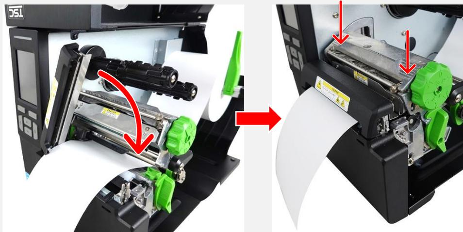
6. Закройте верхнюю планку затвора резака для носителя без подложки (или отрывного).
