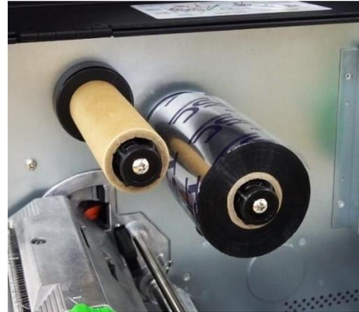
2. Insérez le ruban sur l'axe d'alimentation du ruban jusqu'à ce qu'il soit affleurant à la flasque.
