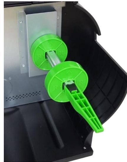
2. Faites glisser la barre de retenue du rouleau d'étiquettes jusqu'à l'extrémité de l'axe, puis faites-la basculer vers le bas.
