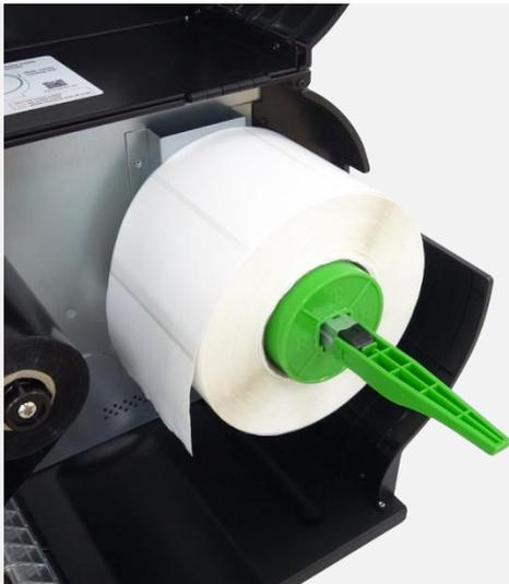
3. Placez le rouleau de consommable sur l'axe d'alimentation d'étiquettes (avec des adaptateurs de 3") et poussez-le jusqu'à l'extrémité de l'axe.
