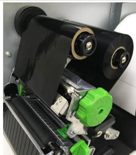
6. Enroulez le ruban sur l'axe de rembobinage. Maintenez le ruban à plat et sans plis.
