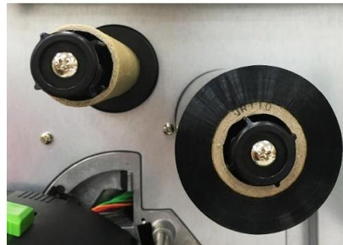
4. Infilare il nastro sotto la barra di guida del nastro e quindi attraverso la fessura del sensore del nastro.
