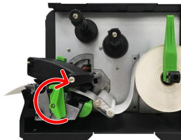
5. Regolare la posizione del sensore del supporto stampabile assicurandosi che il sensore possa rilevare il supporto.
