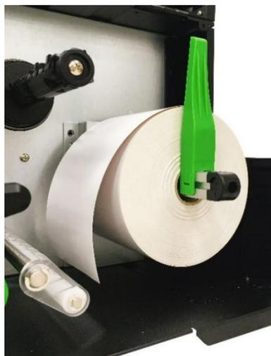
4. Ruotare la leva come indicato per rilasciare la testina di stampa, quindi infilare il supporto sotto lo smorzatore, attraverso il sensore del supporto stampabile e la guida etichette.
