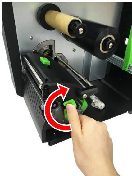
2. Installare il nastro sul mandrino di fornitura nastro e installare l'anima di cartone sul mandrino di riavvolgimento nastro.
