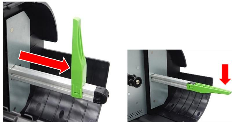
3. Caricare il rotolo supporto e sollevare la protezione del rotolo supporto per fissare il rotolo supporto in posizione.
