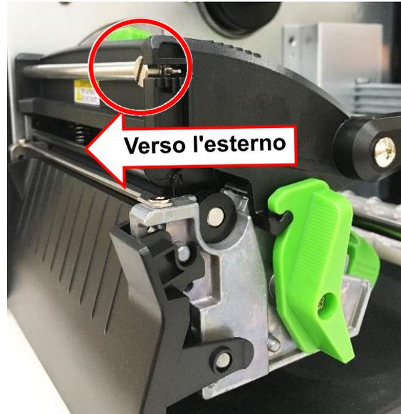
1. Girare il regolatore tensione nastro in senso antiorario per 1 livello e stampare di nuovo l'etichetta per controllare se l'increspamento sparisce.
