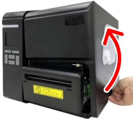
2. Caricare il nastro e il rotolo supporto. Per informazioni su come caricare il nastro e il rotolo supporto, fare riferimento a [Caricamento del nastro](#) e [Caricamento del supporto](#).
