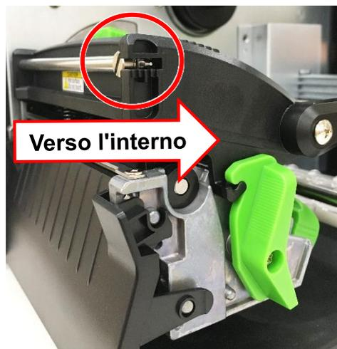
1. Girare il regolatore tensione nastro in senso orario per 1 livello e stampare di nuovo l'etichetta per controllare se l'increspamento sparisce.
