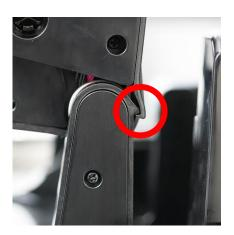
9. При использовании этикеток с черными метками отрегулируйте положение датчика черной метки, чтобы датчик черной метки был совмещен с траекторией черных меток.
