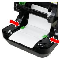
12. Закройте механизм печатающей головки руками, чтобы механизм печатающей головки был надежно закреплен на месте.
