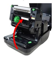
6. Закрепите механизм печатающей головки на месте.
