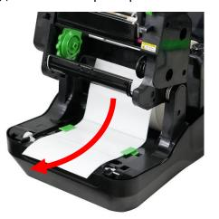
11. Отрегулируйте направляющие носителя так, чтобы они соответствовали ширине носителя.
