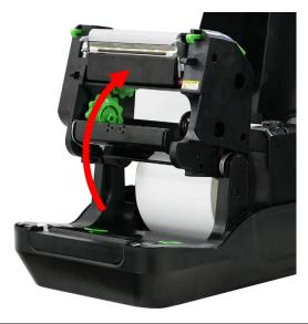
8. Убедитесь, что механизм печатающей головки закреплен на месте.
