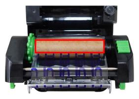
12. Поворачивайте шестерню в указанном направлении, пока лента полностью не закроет печатающую головку.
