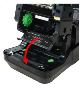
8. С усилием наденьте правую сторону вал сматывателя ленты на правый подпружиненный вал, затем совместите левую сторону вала сматывателя с втулкой левого вала так, чтобы выступы на механизме попали в вал сматывателя ленты.
