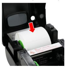
5. Поверните рулон носителя, чтобы он был надлежащим образом закреплен и плавно вращался.
