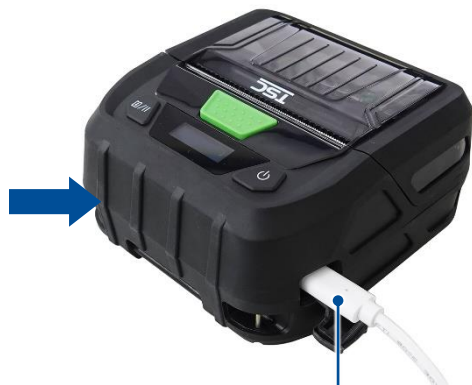
Подключите прилагаемый кабель USB к принтеру.
