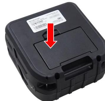
3. Tirare il fermo della batteria per bloccare la batteria in posizione.
