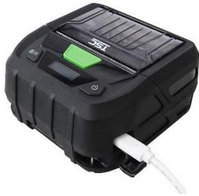
3. Inserire il cavo di alimentazione in una presa di corrente adatta. In alternativa, è possibile collegare il cavo di alimentazione al connettore USB del computer.
