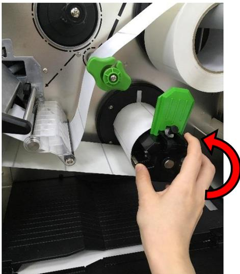
8. Wickeln Sie das Etikett um die interne Aufwickelspindel und befestigen es mit einem Stückchen Klebeband an der Walze. Wickeln Sie die Spindel gegen den Uhrzeigersinn auf, bis das Etikett ausreichend straff gezogen ist.
