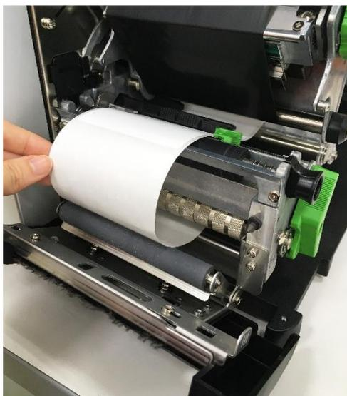
6. Führen Sie die Vorderkante des Tragbands durch die Abziehrolle.
