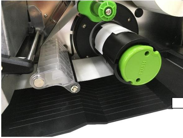
7. Wickeln Sie das Tragband auf die Aufwickelwalze und kleben Sie es an die Spindel. Wickeln Sie die Spindel auf, bis das Tragband ausreichend straff gezogen ist.
