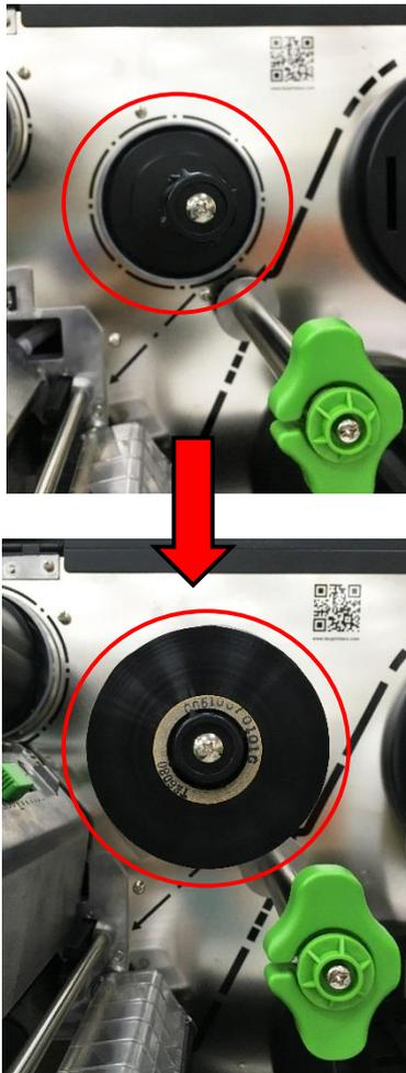
2. Installieren Sie das Farbband auf der Farbbandversorgungsspindel.
