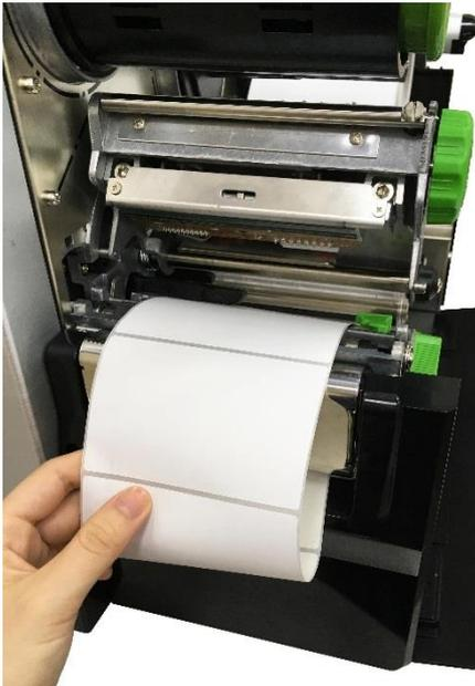
6. Öffnen Sie den Druckkopf-Freigabehebel und den Etikettenführungsschiene-Freigabehebel und ziehen Sie etwa 650 mm des Mediums durch die Vorderseite des Druckers.
