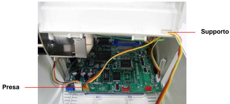
**Figura 16. Sistemazione del cablaggio del modulo della taglierina**
